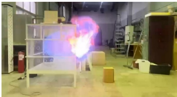
Рис. 1. Этапы внешнего взрыва при срабатывании легкообрасываемой конструкции
