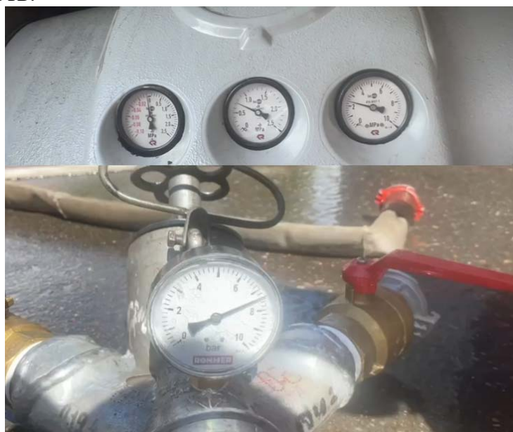
Рис. 3. Результаты измерений на потерю давления
