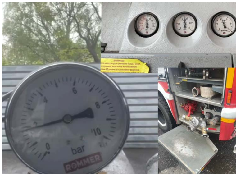
Рис. 2. Проверка герметичности посредством метода гидростатического давления
