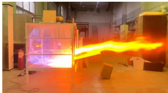
Рис. 1. Этапы внешнего взрыва при срабатывании легкообрасываемой конструкции
