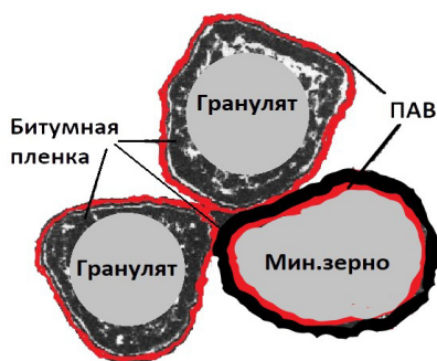
Рис. 10. Распределение ПАВ по поверхности битумных пленок на зернах минеральной части смеси и гранулята
