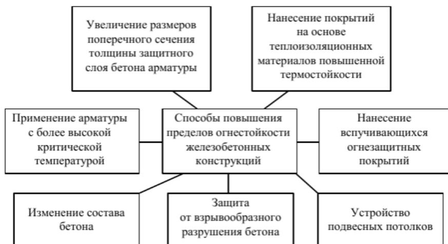
Рис. 4. Способы повышения пределов огнестойкости железобетонных конструкций
