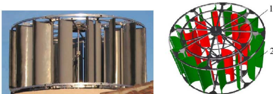
Рис. 1. Вертикальная ВЭУ с регулируемым направляющим аппаратом
