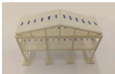
Рис. 4. Фотографии макета одной секции железобетонного каркаса промышленного здания
