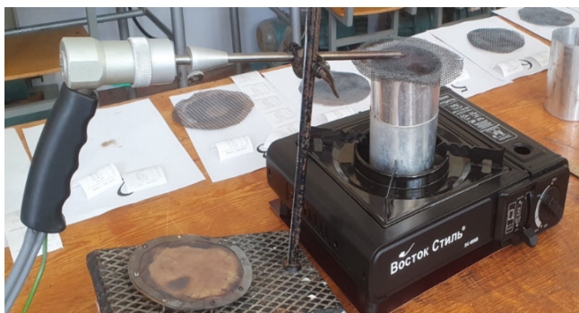
Рис. 3. Общий вид установки с подключенным датчиком газоанализатора
