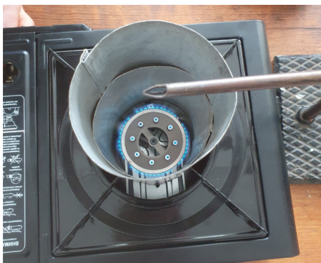
Рис. 4. Калибровка местоположения датчика газоанализатора ДАГ-510 ГВ над третьей секцией относительно пламени горелки при минимальном режиме работы
