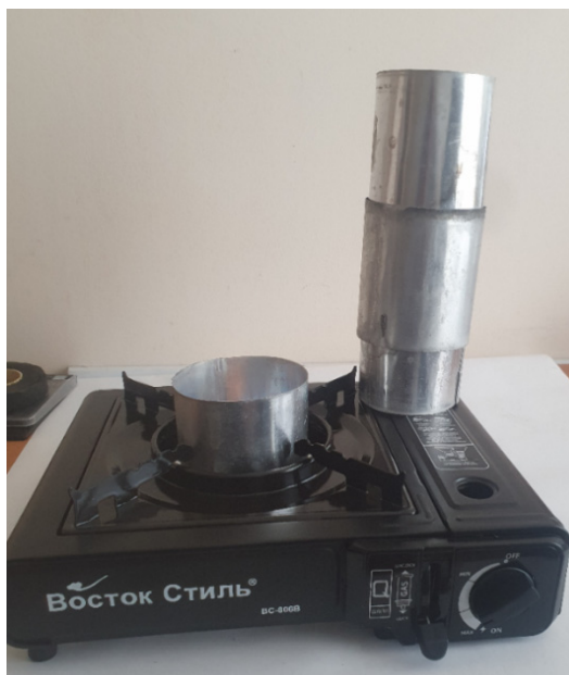
Рис. 1. Схема и внешний вид экспериментальной установки по исследованию влияния эффективности работы каталитических сеток дожигателя на состав продуктов сгорания в горелочном устройстве: 1 — регулятор подачи газа; 2 — штуцер соединительный для внешнего баллона газа; 3 — фиксатор соединительный для внутреннего баллона газа; 4 — телескопическая алюминиевая труба; 5 — место установка каталитической сетки дожигателя
