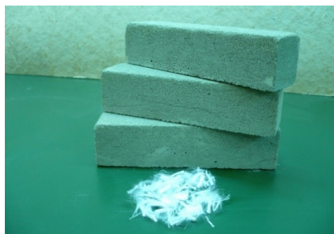
Рис. 3. Образцы бетона с применением полипропиленовой фибры
