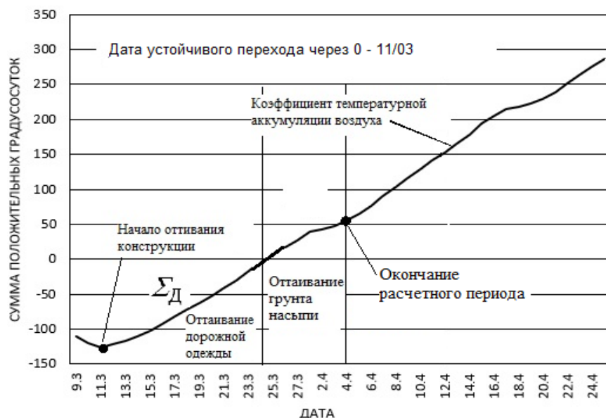
Рис. 8. Расчетная схема прогнозирования оттаивания дорожной конструкции на основе графика температурной аккумуляции
