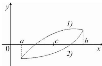
Рис. 6. Графическая иллюстрация метода половинного деления
