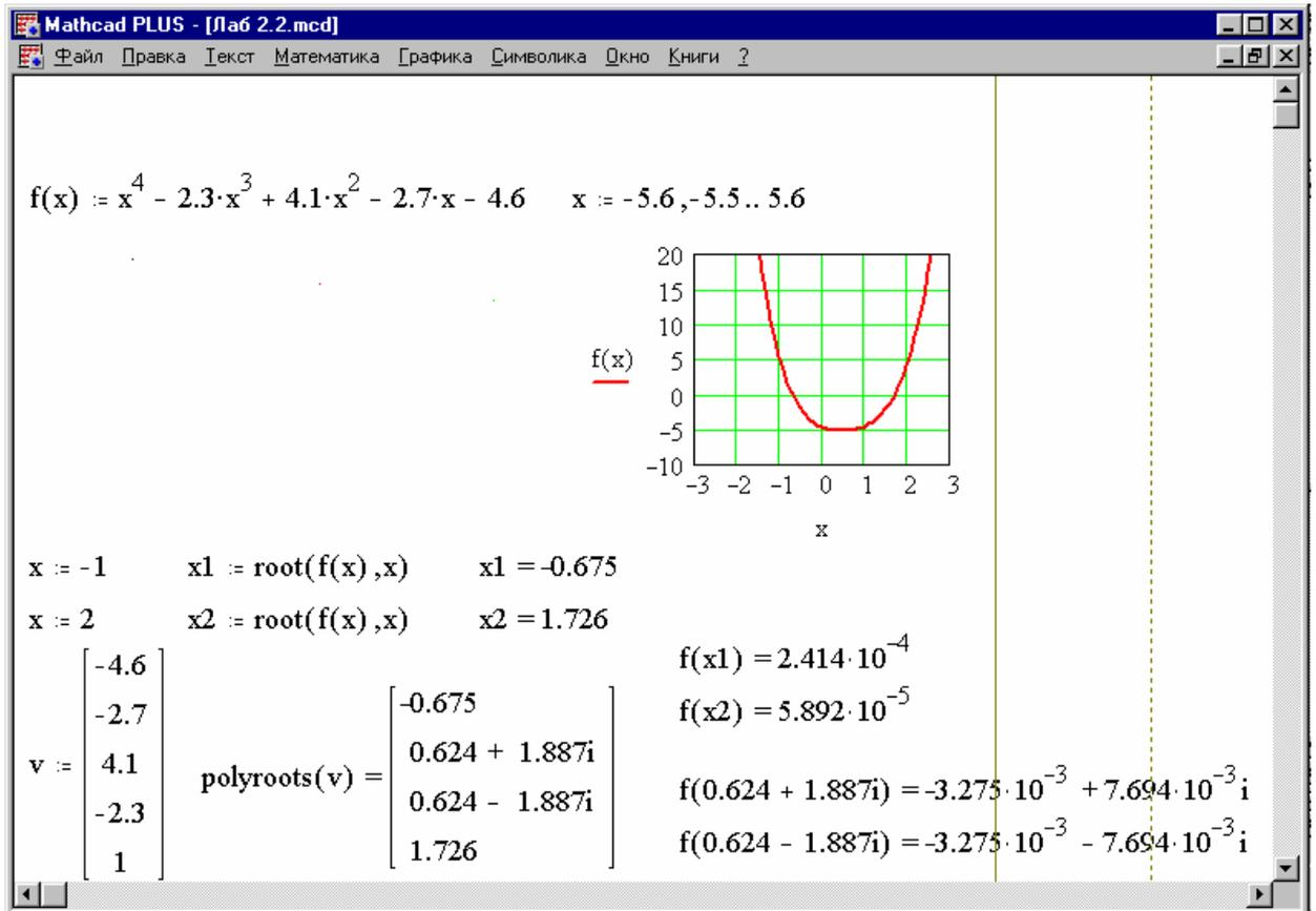
Рис. 8. Решение уравнения с использованием функции root
