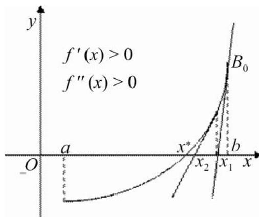
Рис. 7. Геометрическая интерпретация метода касательных
