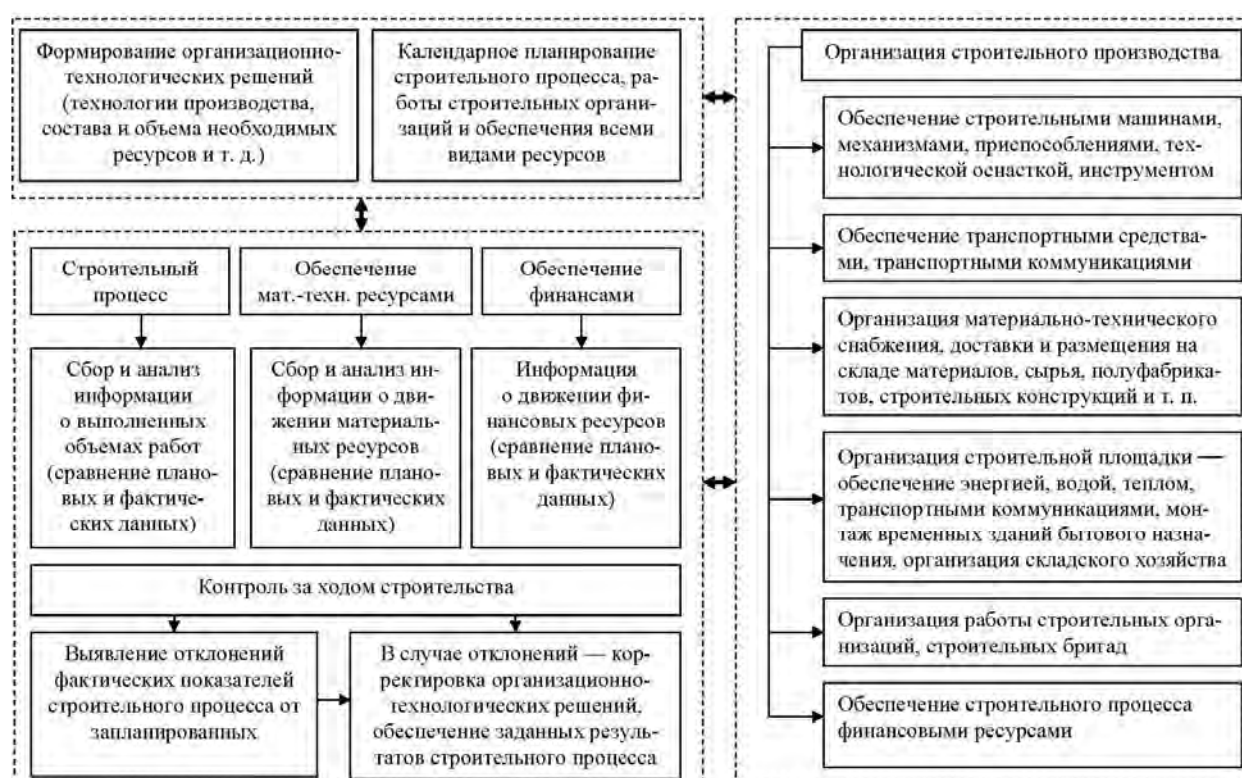
Рис. 2.1. Схема взаимодействия задач организационно-технологического проектирования, организации и управления строительным производством
