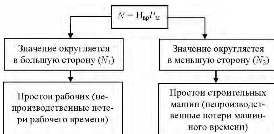
Рис. 3.3. Варианты формирования технологической системы «машина(ы) — рабочие»
