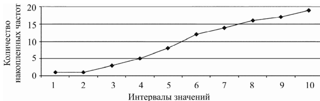
Рис. 3.13. Кумулятивная кривая накопленных частот по условию «не более» для значений нормы времени
