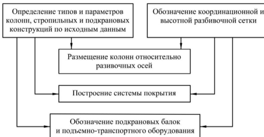
Рисунок 19б. Расстановка конструктивных элементов на плане и обозначение подъемно-транспортного оборудования
