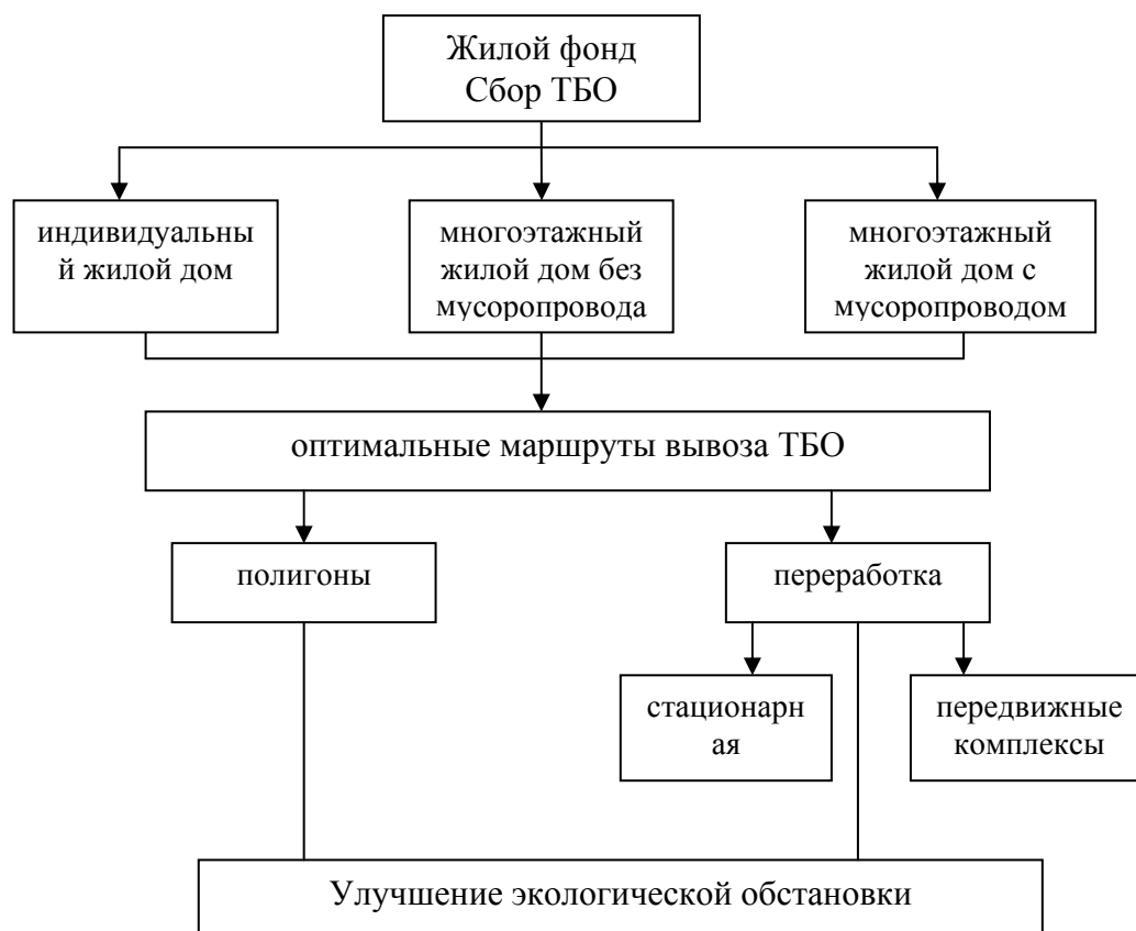
Рис. 3 Схема организации ликвидации несанкционированных свалок.
