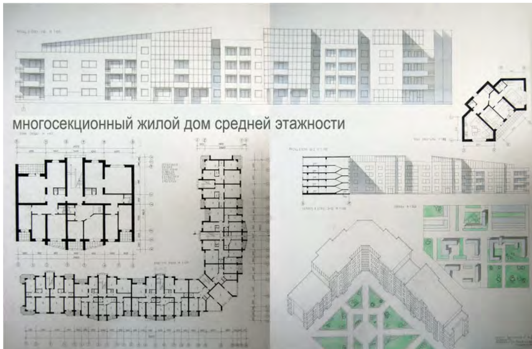
Рис. П.36. Жилой дом средней этажности, многосекционный с поворотной секцией
