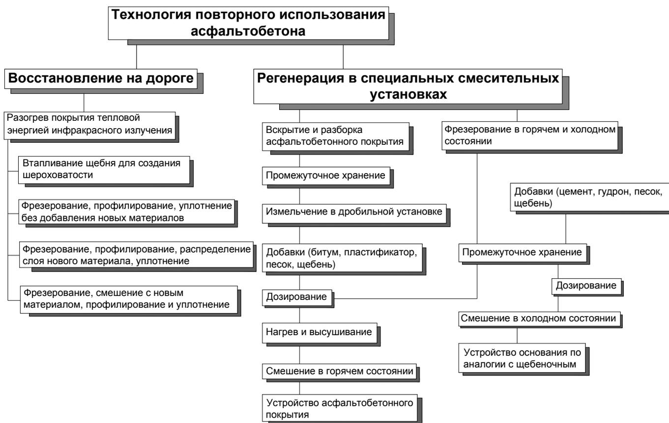
Рис. 1. Классификация способов повторного использования асфальтобетона
