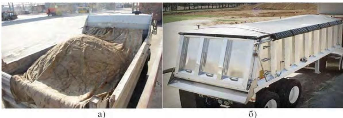
Рис. 2 Использование тента для теплоизоляции асфальтобетонной смеси во время транспортировки: а – малоэффективный способ, б – эффективный способ
