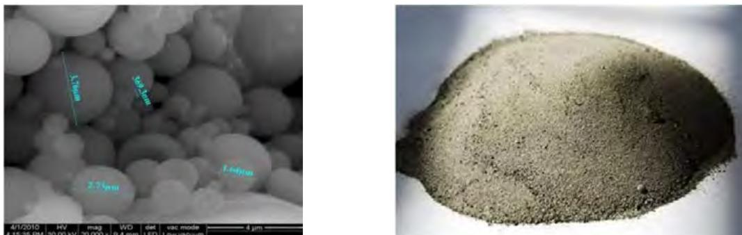
Рис. 5. Золошлаковая смесь: а) вид золошлаковой смеси под микроскопом; б) образец золошлаковой смеси
