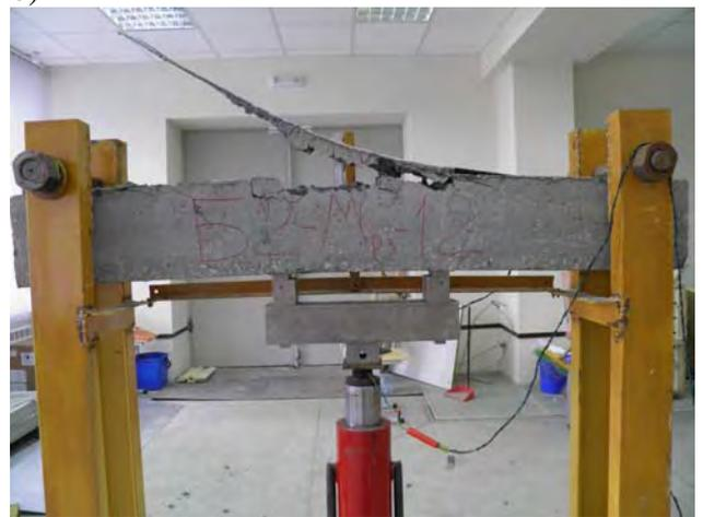
Рис. 4 Вид усиленных образцов после испытания на прочность предварительно подвигнутых: а) 8 циклам попеременного замораживания и оттаивания; б) 12 циклам попеременного замораживания и оттаивания
