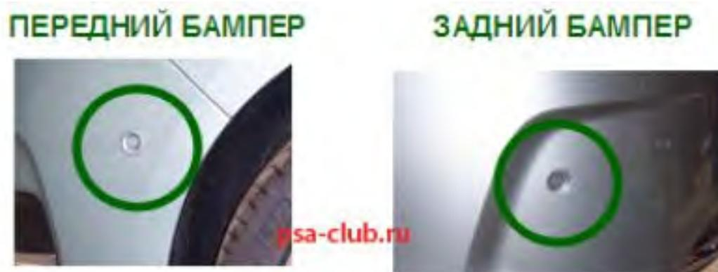
Рис. 3. Расположение датчиков обнаружения препятствия
