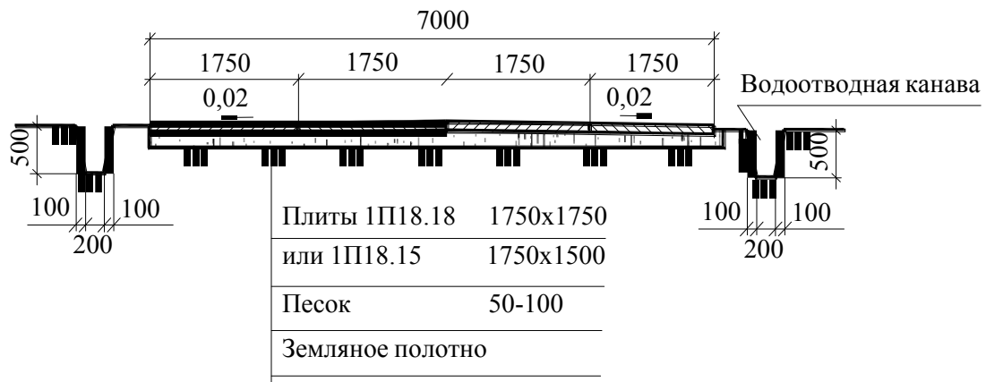
Рис. П.1.6. Тип 5 — двускатная дорога из сборных железобетонных плит шириной 7 м из плит 1750 × 1750
