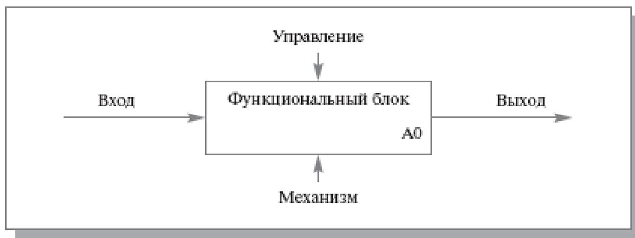
Рис. 6. Функциональный блок
