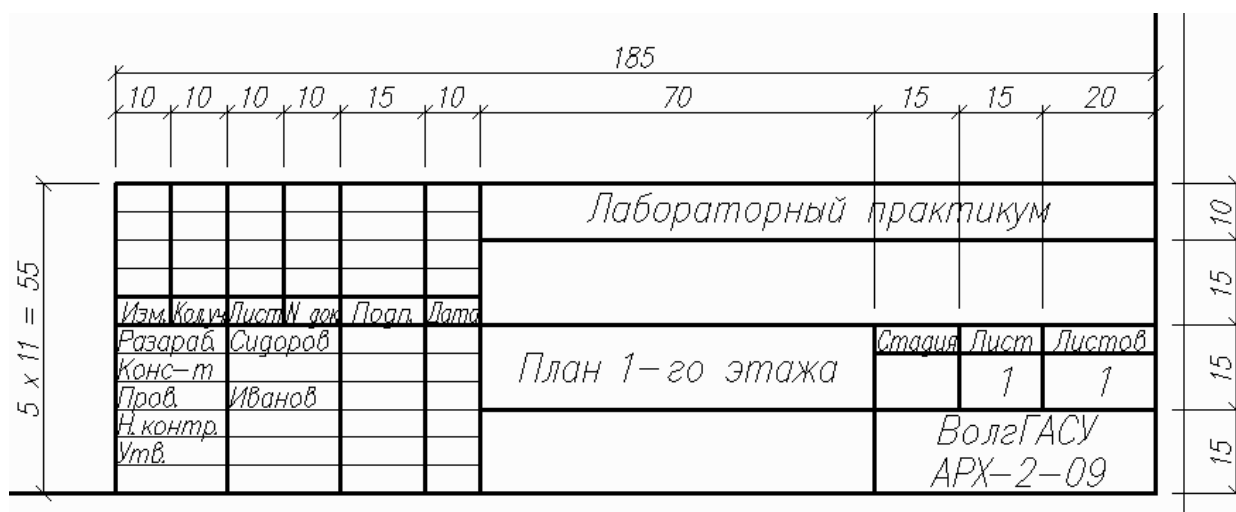
Рис. 24. Вид и размеры основной надписи по ГОСТ 21.101—97
