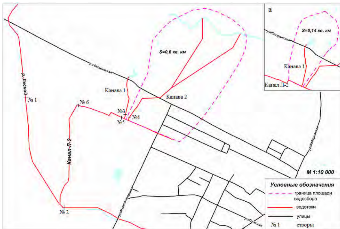
Рисунок 1 – Схема площади водосбора канала Л-2 и размещения створов; а – схема площади водосбора канавы 2
