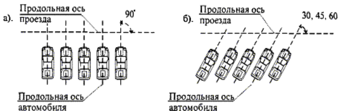
Рис. 4.2. Схемы расстановки автомобиля в зоне хранения а) прямоугольная; б) косоугольная
