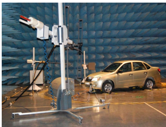
Рис. 1. Камера для акустических испытаний легковых автомобилей на Автовазе
