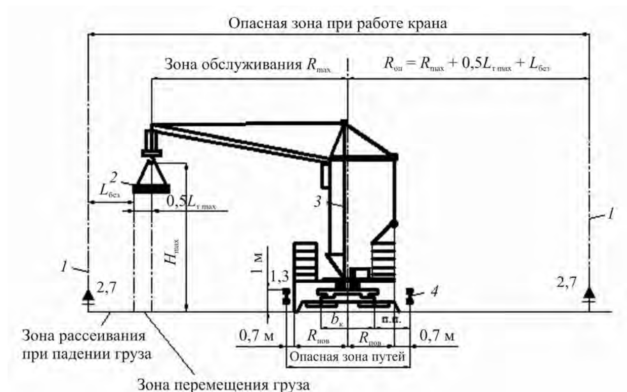
Рис. 4.7. Схема расчета зон влияния башенного крана: 1 — знак по технике безопасности на границе опасной зоны; 2 — груз; 3 — ось подкрановых путей; 4 — ограждение опасной зоны крана
