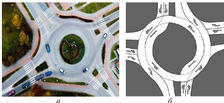
Рис.1. Пример кольцевого (а) и турбокольцевого (б) пересечения
