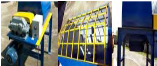
Рис. 1. Одновальный бетоносмеситель БП-1Г-100:
