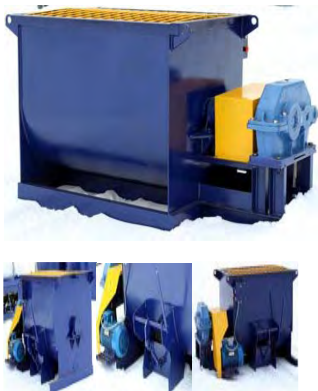
Рис. 2. Одновальный бетоносмеситель БП-1Г-450:
