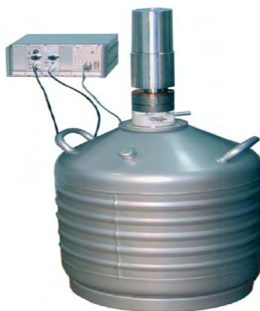
Рис – Гамма-спектрометр с полупроводниковым детектором
