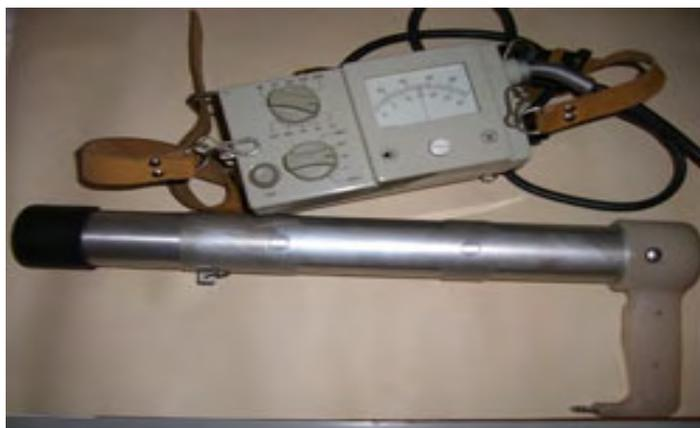
Рис. – Сцинтилляционный дозиметр СРП-68-01
