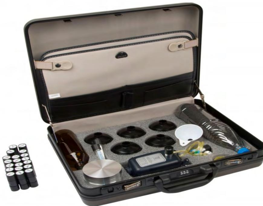
Рис – Оборудование для отбора проб  $^{222}\text{Rn}$
