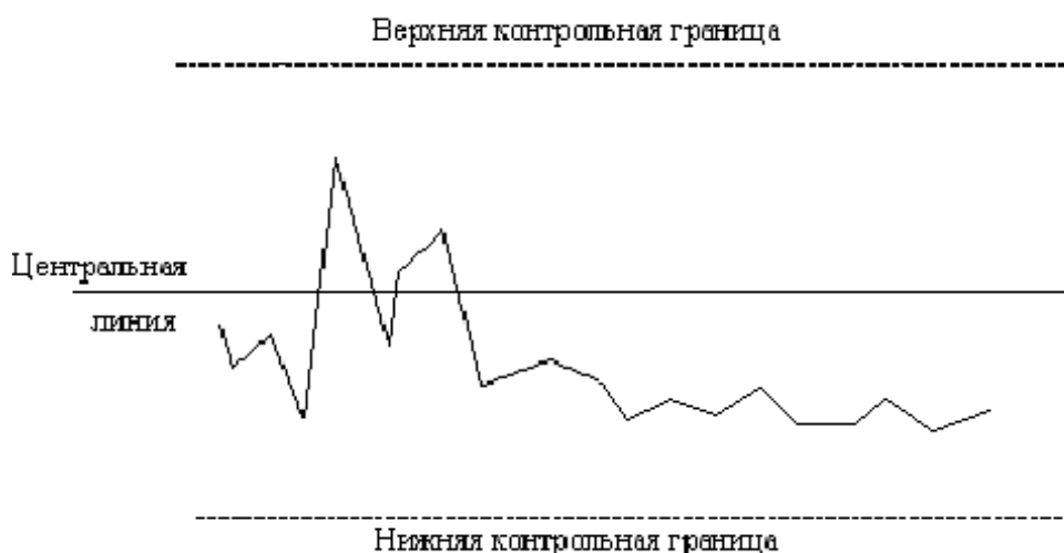
Рис. 3.13. Изменение средних результатов измерений относительно центральной линии
