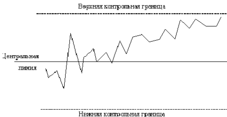
Рис. 3.14. Формирование тренда средних значений измерений в сторону одной из контрольных границ
