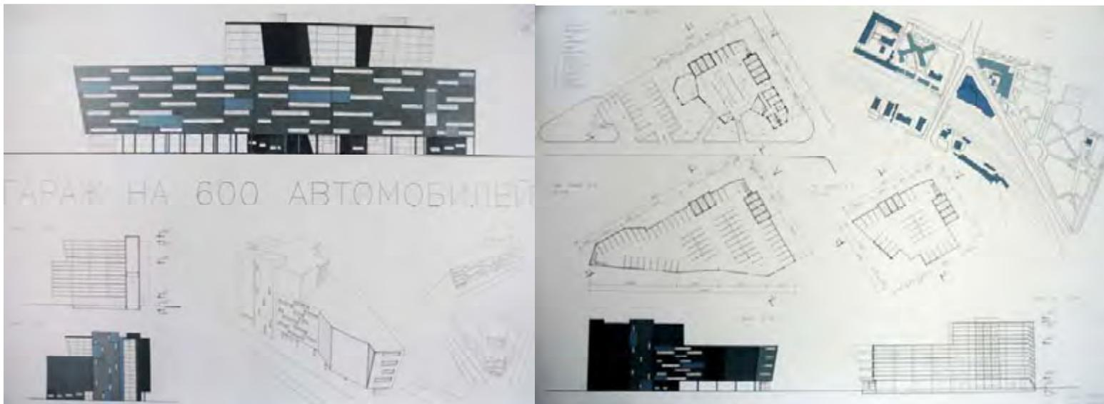
Рис. 22. Многоэтажный гараж на 600 легковых автомобилей. Образец курсового проекта. Состав чертежей и их расположение на листе
