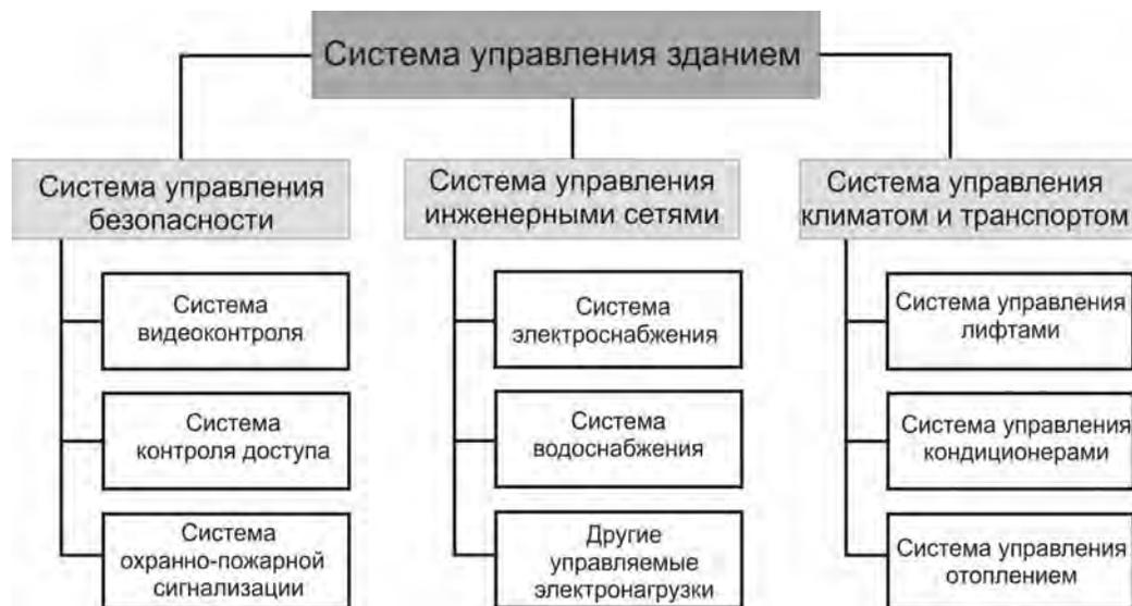
Рис. 1. Структурная схема системы управления зданием
