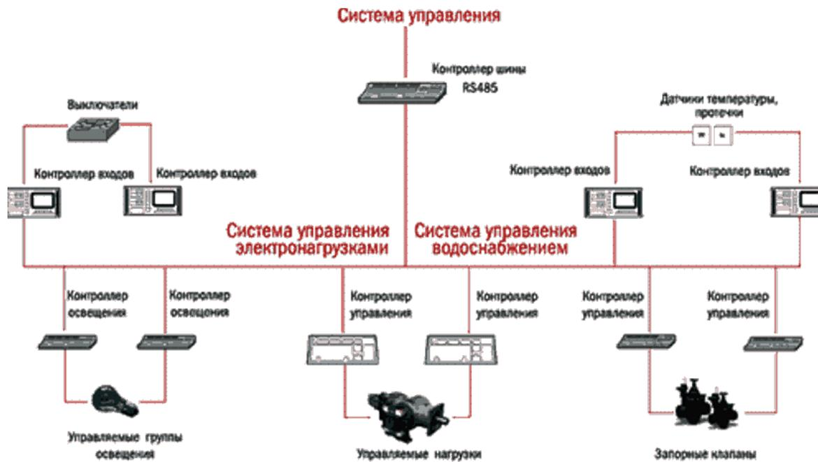
Рис. 3. Структурная схема интегрированной системы автоматизации
