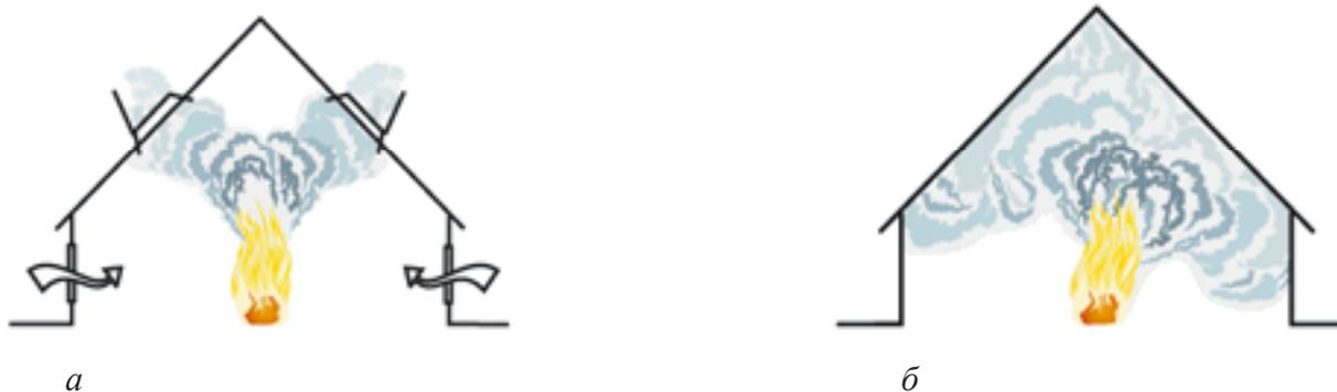
Рис. 15. Принцип работы системы дымоудаления: *а* — с применением системы дымоудаления; *б* — без применения данной системы
