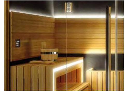
Светильники в сауне и бане должны быть безопасными. Для этого оптимально подходят светодиодные ленты, скрытые за пластиком или оргстеклом
