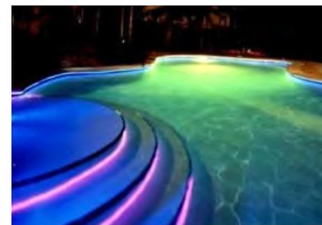
Один из вариантов подсветки бассейна предусматривает прокладку оптоволоконного кабеля по периметру бассейна, только кабель должен быть при этом бокового свечения
