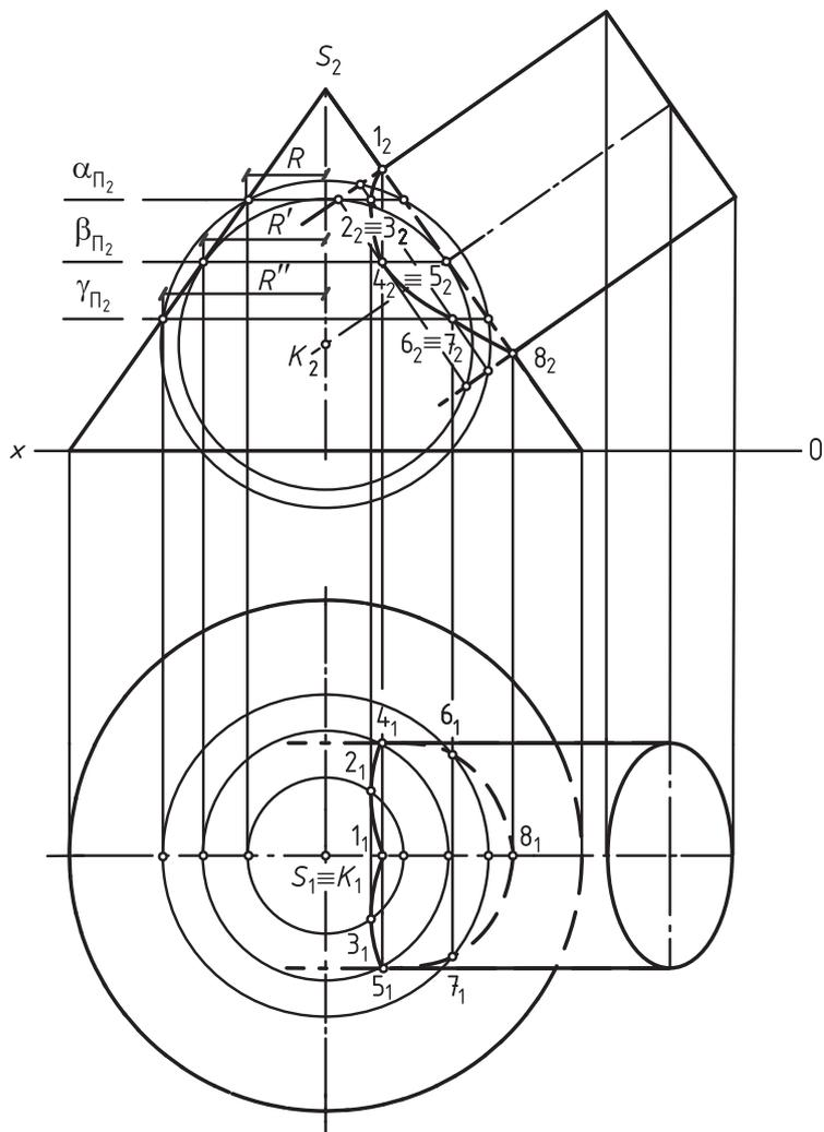
Рис. 118. Пересечение прямого кругового конуса и наклонного цилиндра
