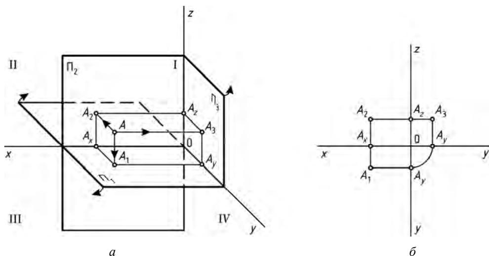
Рис. 5. Проекция точки на три плоскости проекций
