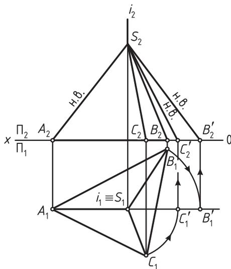
Рис. 51. Определение натуральной длины ребер пирамиды
