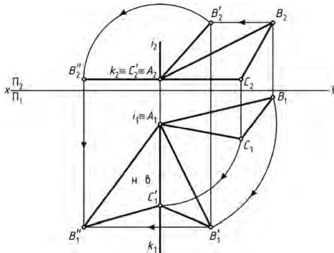
Рис. 48. Определение натуральной величины плоскости  $\Delta ABC$  (вариант 1)
