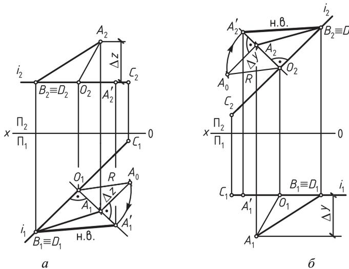
Рис. 54. Определение натуральной длины прямой
