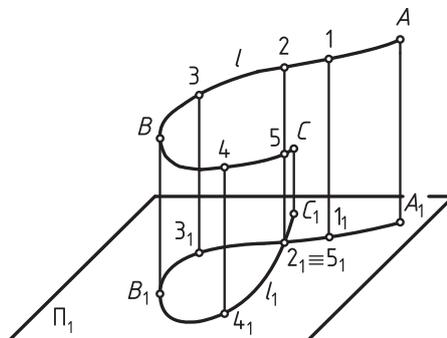
Рис. 8. Построение проекции кривой линии
