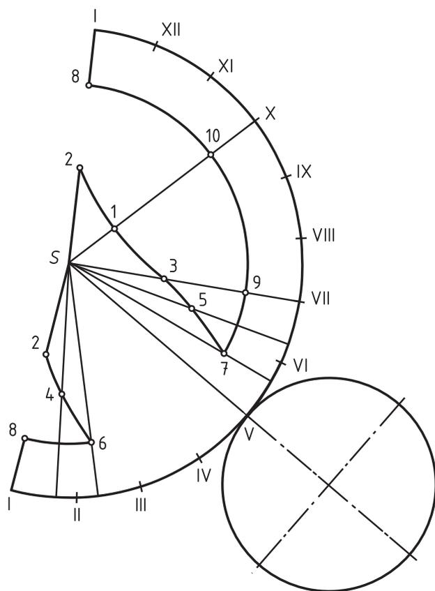
Рис. 82. Развертка прямого конуса с нанесением линии выреза
