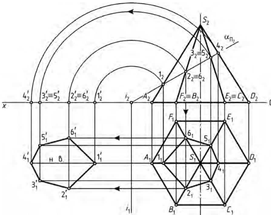
Рис. 90. Пересечение прямой пирамиды плоскостью частного положения
