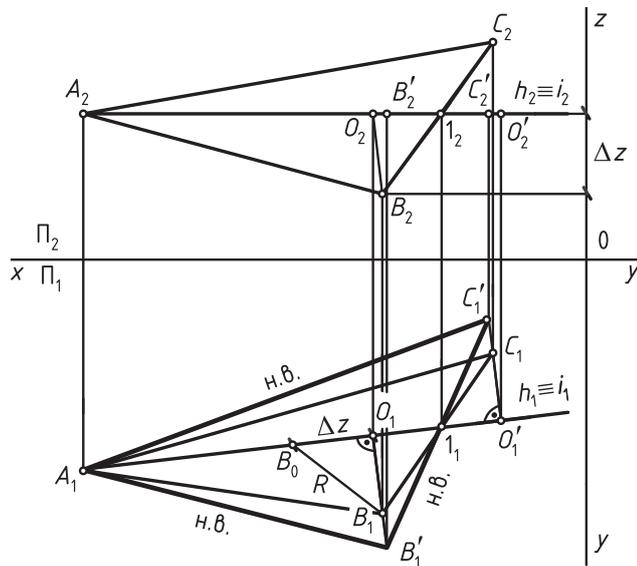
Рис. 55. Определение натуральной величины плоскости  $\Delta ABC$  вращением вокруг горизонтали
