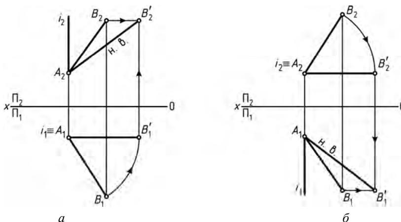
Рис. 46. Определение натуральной длины прямой
