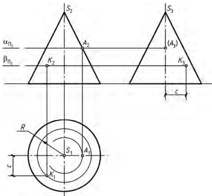
Рис. 69. Проекция точек на поверхности прямого конуса, получаемые с помощью вспомогательной параллели
