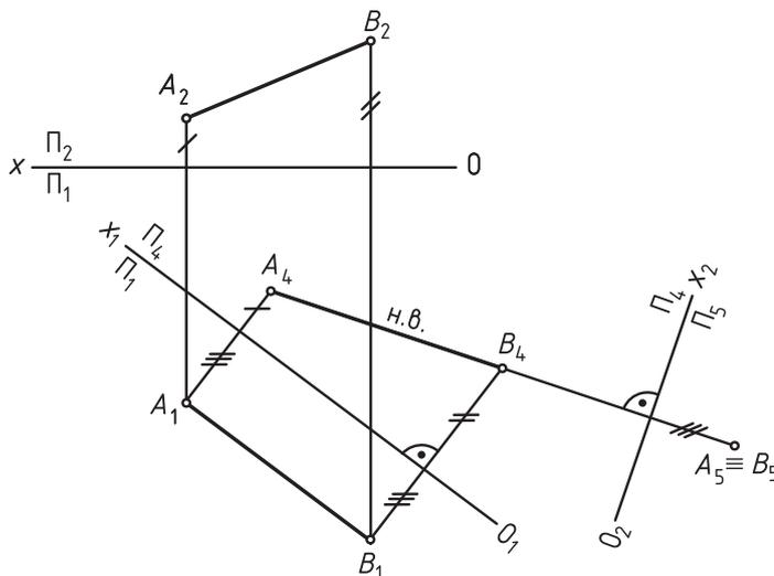
Рис. 40. Преобразование прямой из общего положения в проецирующее
