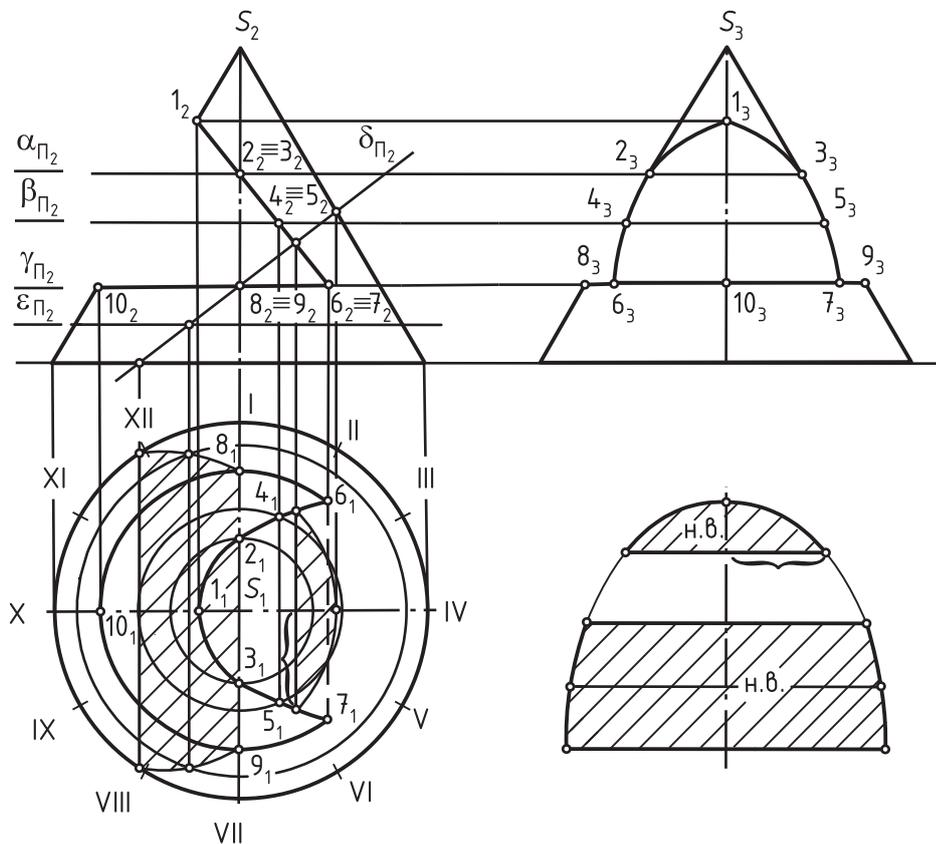
Рис. 81. Проекции прямого конуса с вырезом и натуральная величина сечения цилиндра плоскостью  $\delta$
