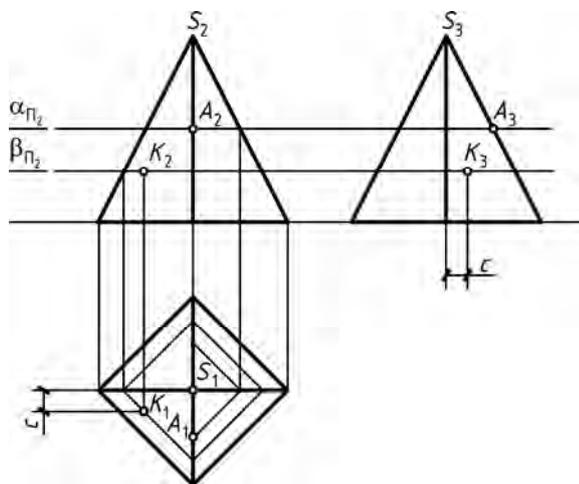
Рис. 63. Проекция точек на поверхности прямой пирамиды, получаемые с помощью вспомогательной плоскости уровня
