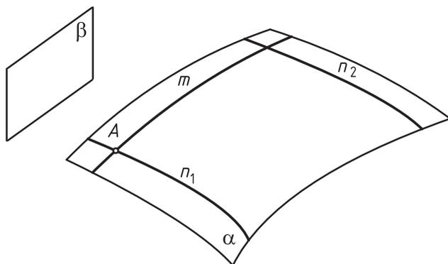
Рис. 57. Кинематический способ образования поверхности
