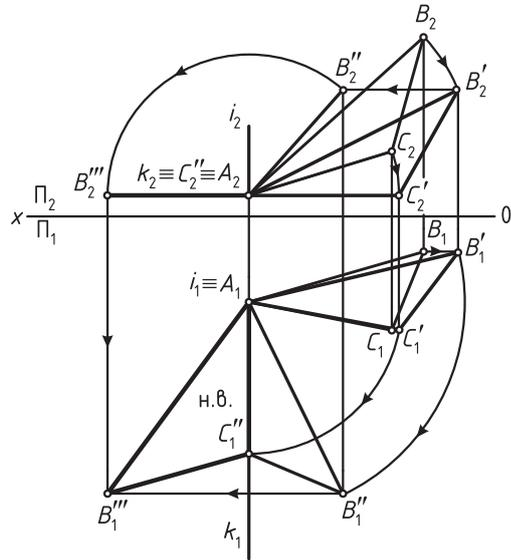
Рис. 49. Определение натуральной величины плоскости  $\Delta ABC$  (вариант 2)
