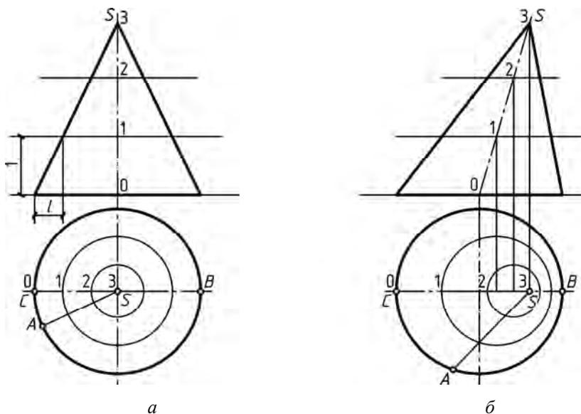
Рис. 130. Криволинейная поверхность в проекциях с числовыми отметками
