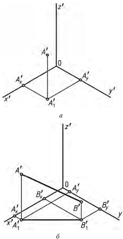
Рис. 144. Аксонометрические проекции точки и прямой
