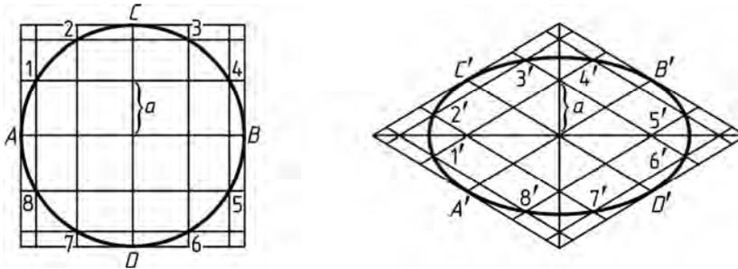
Рис. 147. Аксонометрическая проекция окружности
