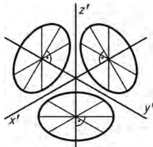
Рис. 148. Аксонометрические проекции окружности
