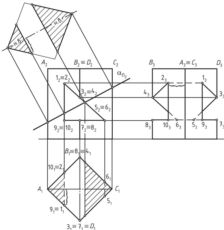
Рис. 75. Проекция прямой призмы с вырезом и натуральная величина сечения призмы плоскостью  $\alpha$
