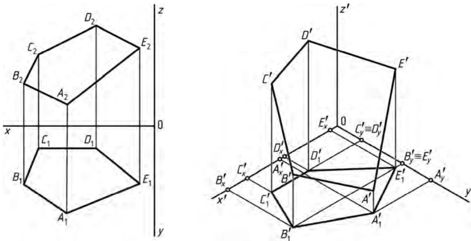
Рис. 145. Аксонометрическая проекция плоской фигуры
