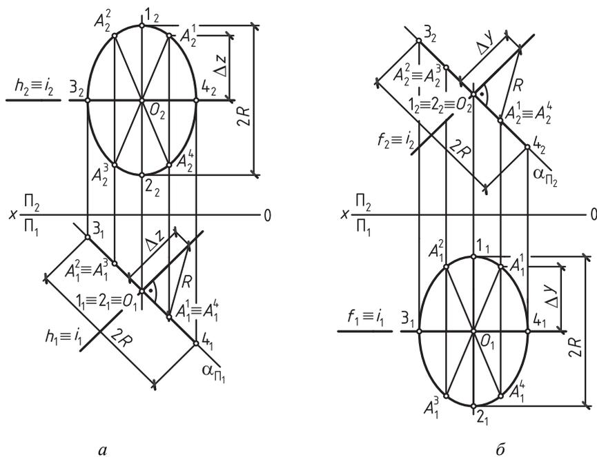
Рис. 52. Проекция точки в способе вращения вокруг оси, параллельной плоскости проекций
