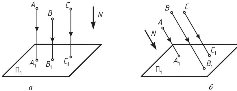
Рис. 2. Метод параллельного проецирования
