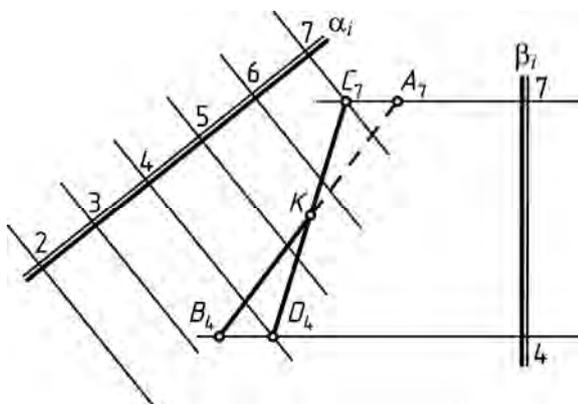
Рис. 128. Пересечение прямой с плоскостью в проекциях с числовыми отметками
