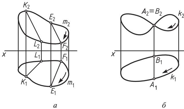
Рис. 9. Проекция пространственных кривых линий
