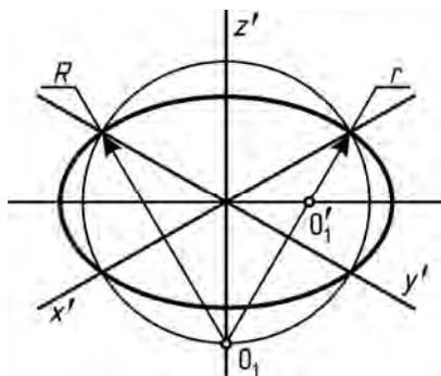
Рис. 149. Построение овала в прямоугольной изометрии
