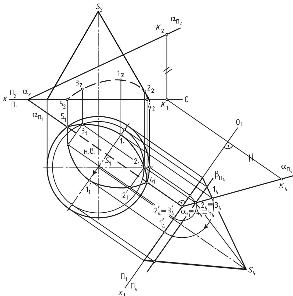
Рис. 103. Пересечение прямого конуса плоскостью общего положения
