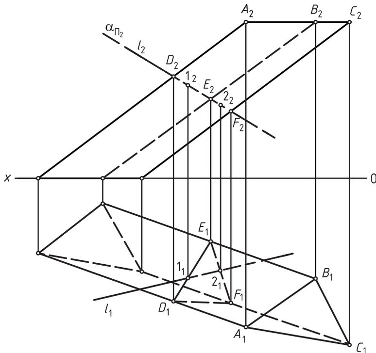
Рис. 112. Пересечение наклонной призмы прямой общего положения
