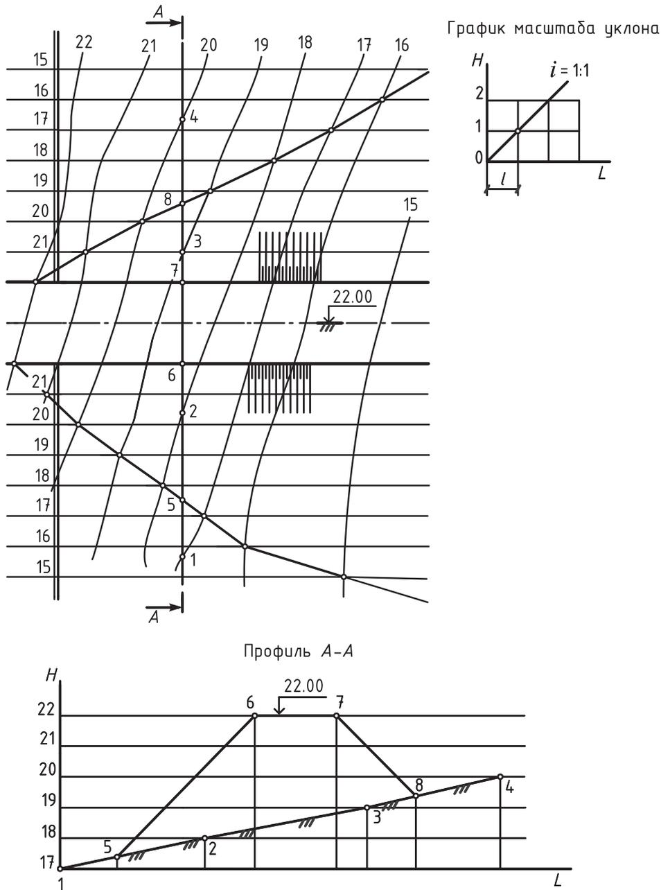
Рис. 140. Проектирование плотины на заданной высотной отметке и построение профиля топографической поверхности и сооружения
