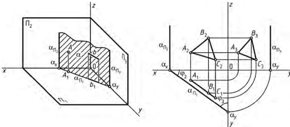
Рис. 24. Горизонтально-проецирующая плоскость
