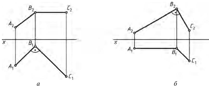
Рис. 17. Проецирование прямого плоского угла
