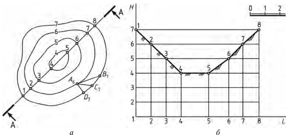
Рис. 133. Топографическая поверхность и ее профиль
