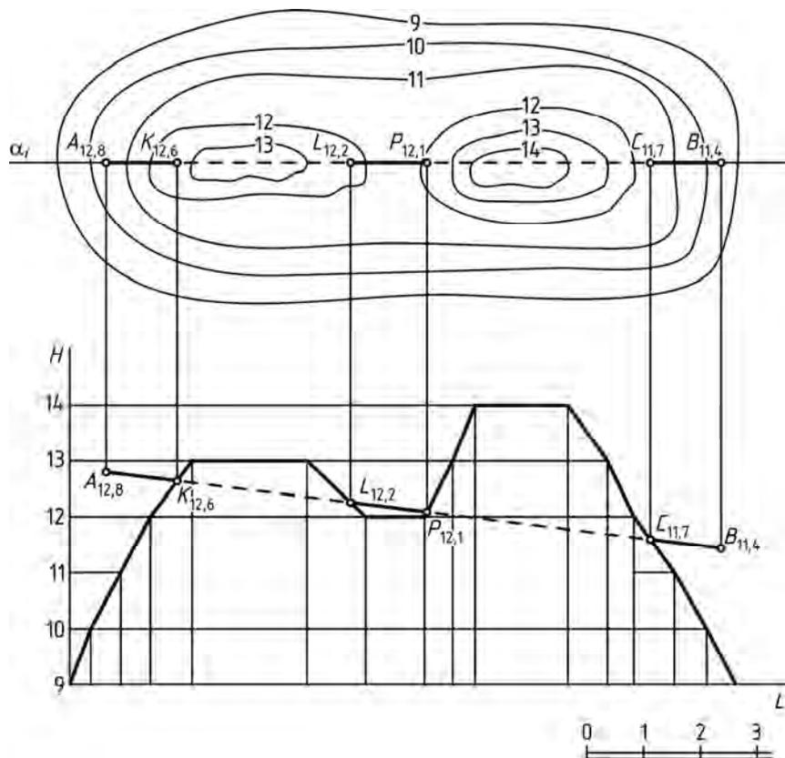
Рис. 136. Пересечение топографической поверхности прямой способом профиля
