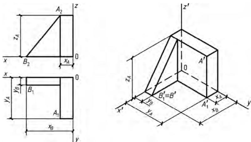
Рис. 146. Аксонометрическая проекция многогранника
