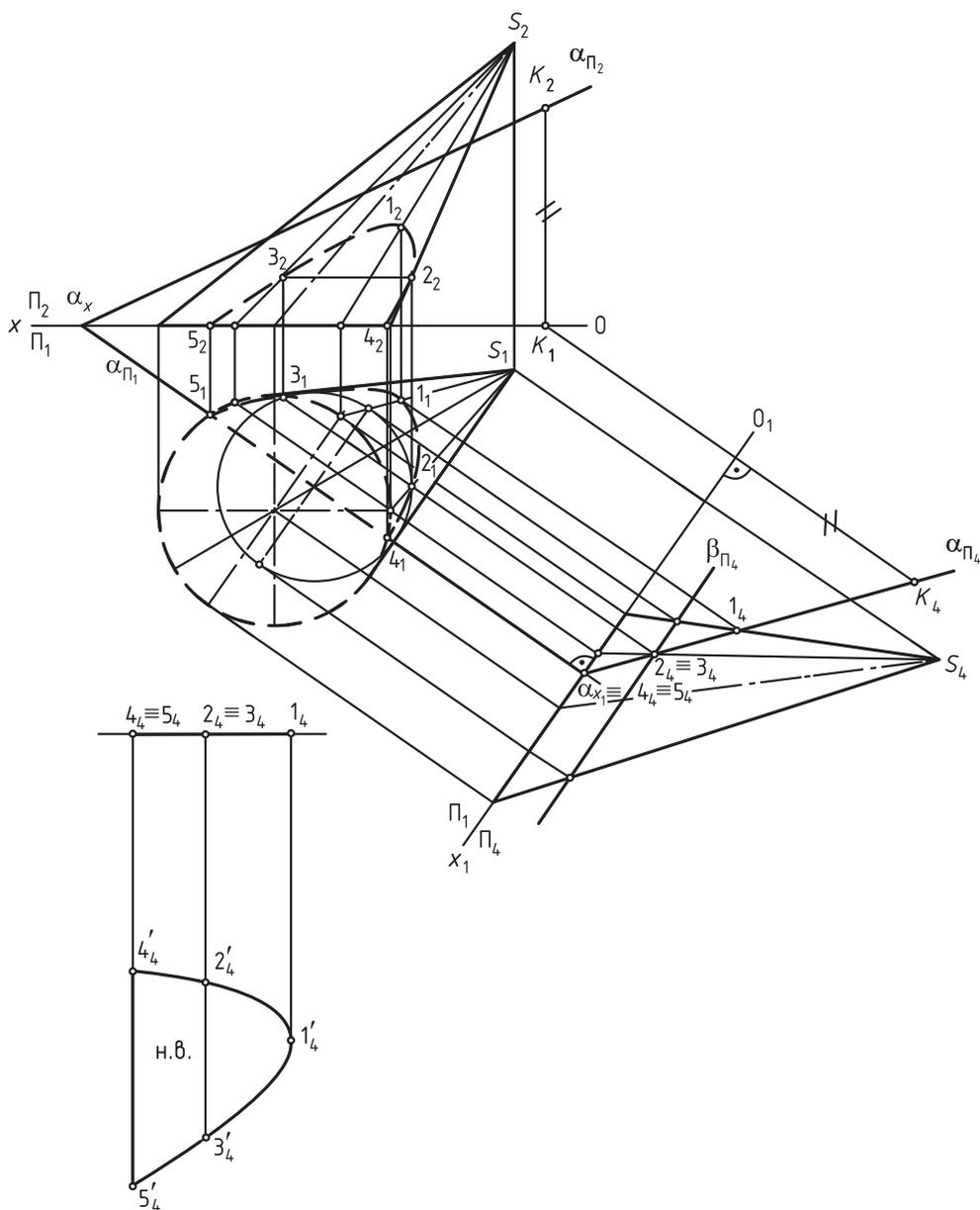
Рис. 104. Пересечение наклонного конуса плоскостью общего положения
