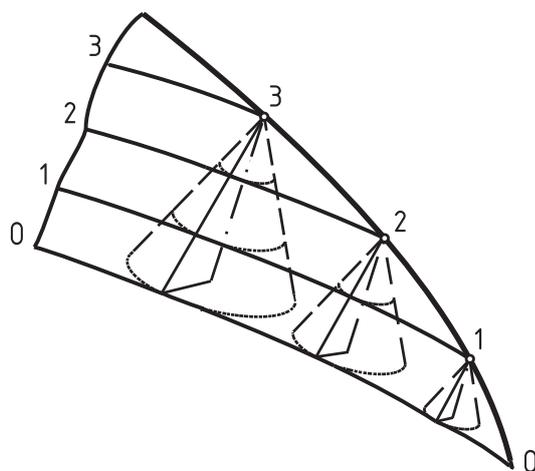
Рис. 131. Образование поверхности постоянного ската
