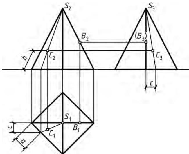
Рис. 62. Проекции точек на поверхности прямой пирамиды, получаемые с помощью образующей
