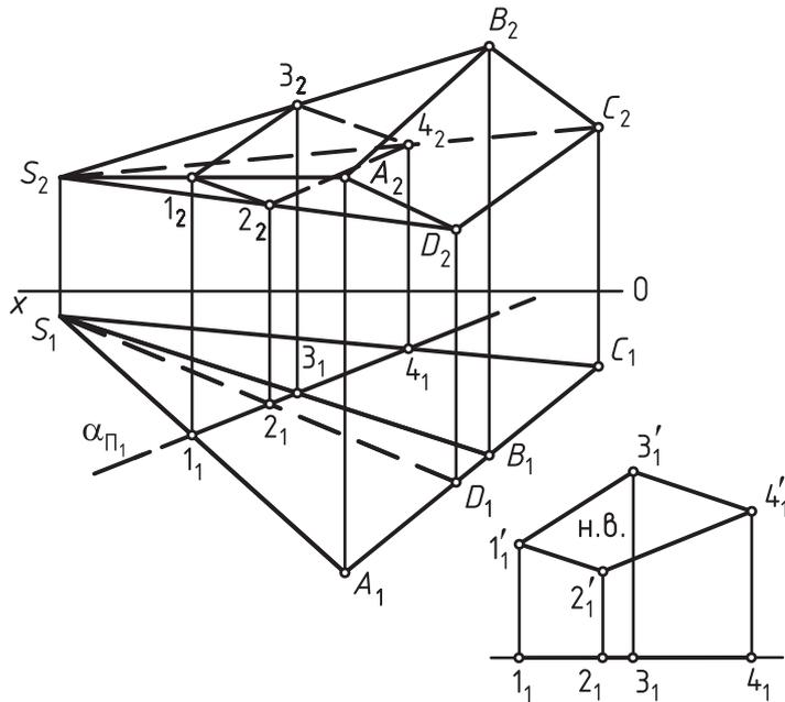
Рис. 92. Пересечение наклонной пирамиды плоскостью частного положения
