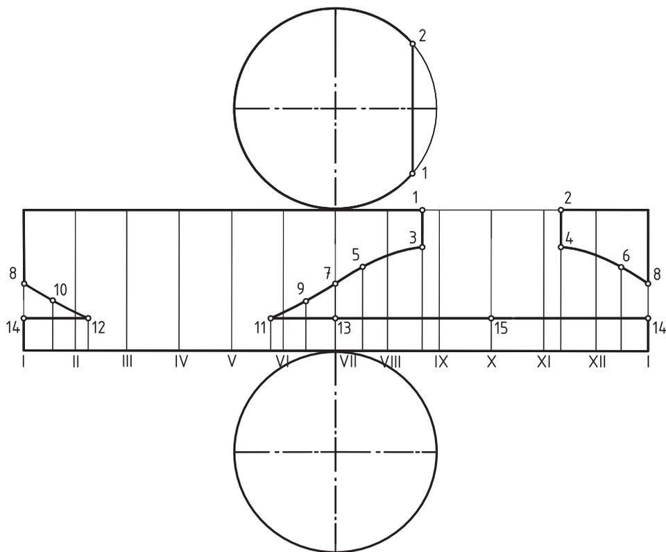
Рис. 80. Развертка прямого цилиндра с нанесением линии выреза
