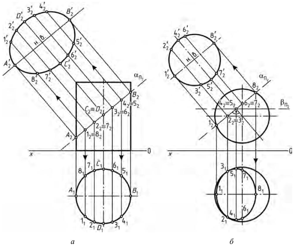
Рис. 95. Пересечение геометрических тел плоскостью частного положения
