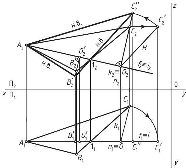
Рис. 56. Определение натуральной величины плоскости  $\Delta ABC$  вращением вокруг фронтали
