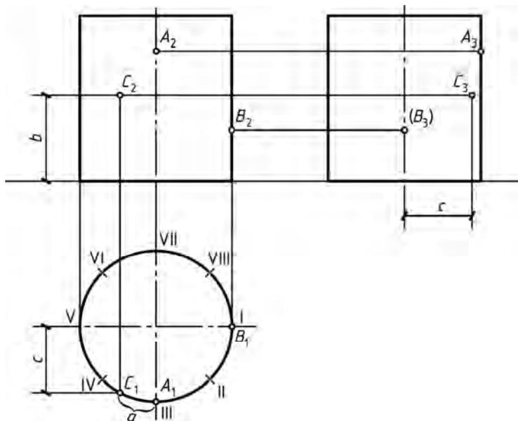
Рис. 66. Проекция точек на поверхности прямого цилиндра
