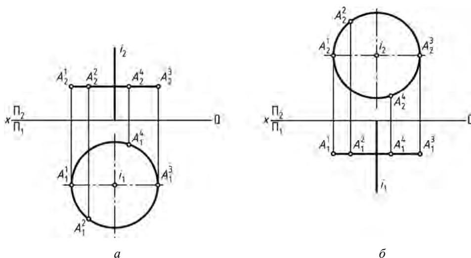
Рис. 45. Проекция точки в способе вращения вокруг оси, перпендикулярной к плоскости проекций
