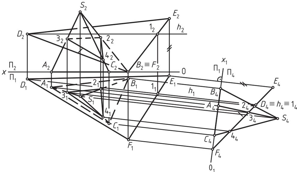
Рис. 98. Пересечение прямой пирамиды плоскостью общего положения  $\alpha$  ( $\triangle DEF$ )
