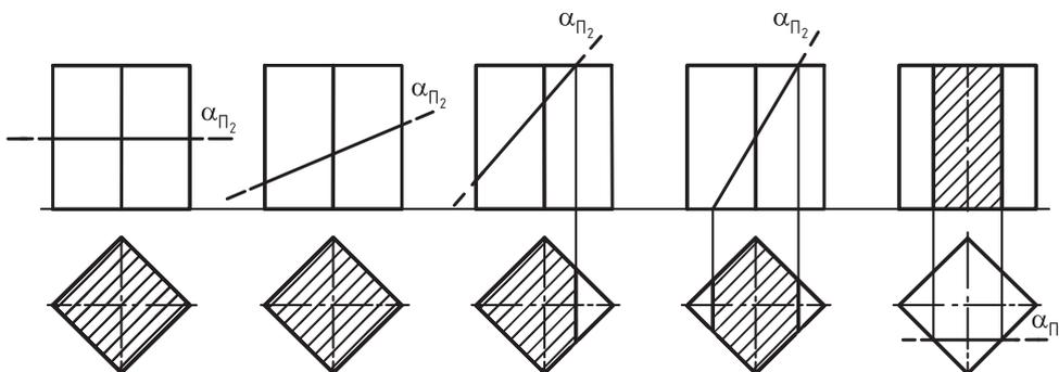
Рис. 88. Сечение прямой призмы плоскостями частного положения
