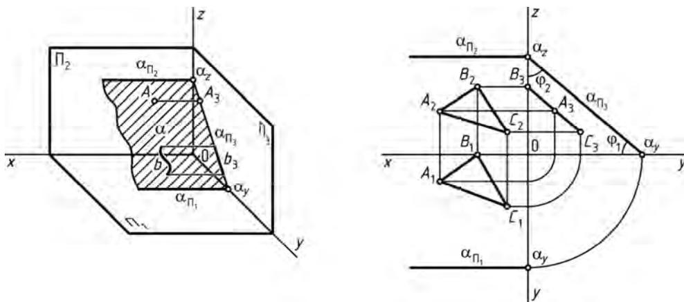
Рис. 26. Профильно-проецирующая плоскость
