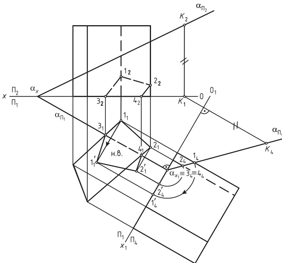
Рис. 99. Пересечение прямой призмы плоскостью общего положения  $\alpha$ , заданной следами
