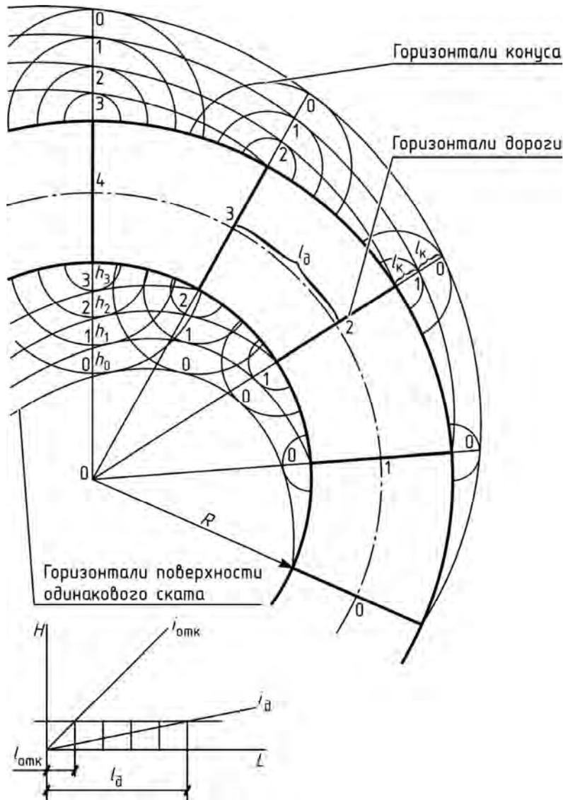
Рис. 132. Криволинейный участок автомобильной дороги
