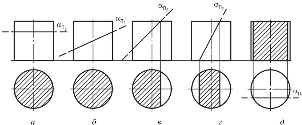
Рис. 93. Пересечение прямого цилиндра плоскостями частного положения
