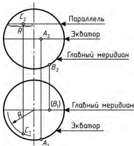
Рис. 72. Проекция точек на поверхности сферы
