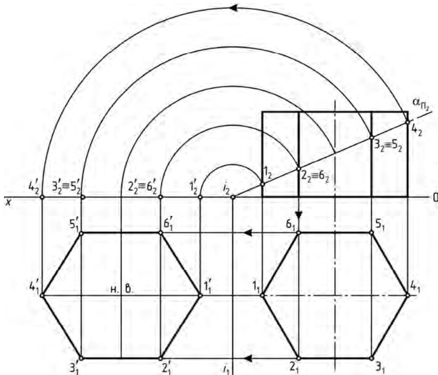
Рис. 91. Пересечение прямой призмы плоскостью частного положения
