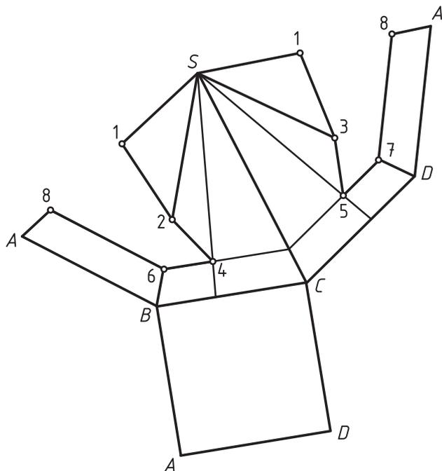
Рис. 78. Развертка прямой пирамиды с нанесением линии выреза
