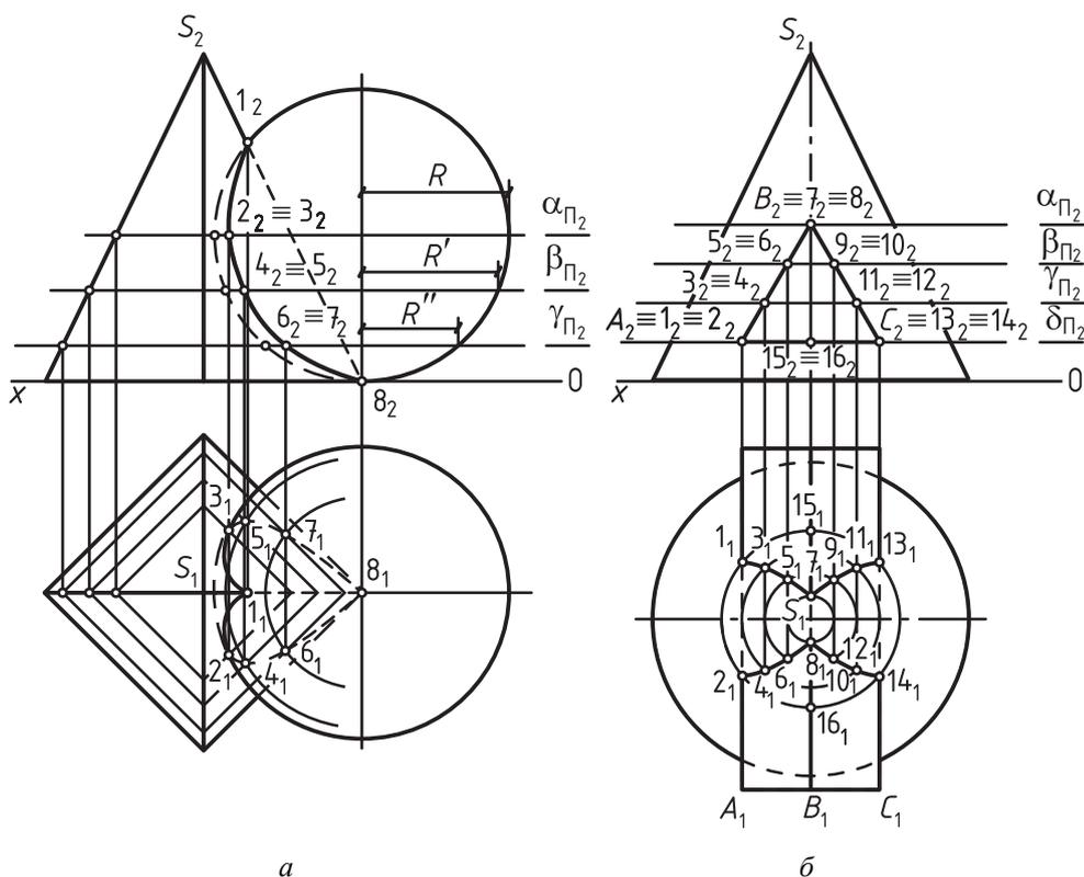
Рис. 114. Пересечение гранных поверхностей и поверхностей вращения
