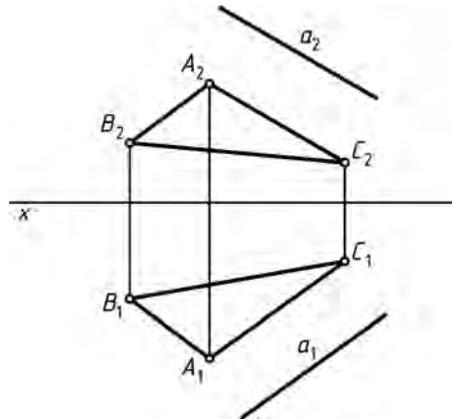
Рис. 35. Прямая, параллельная плоскости
