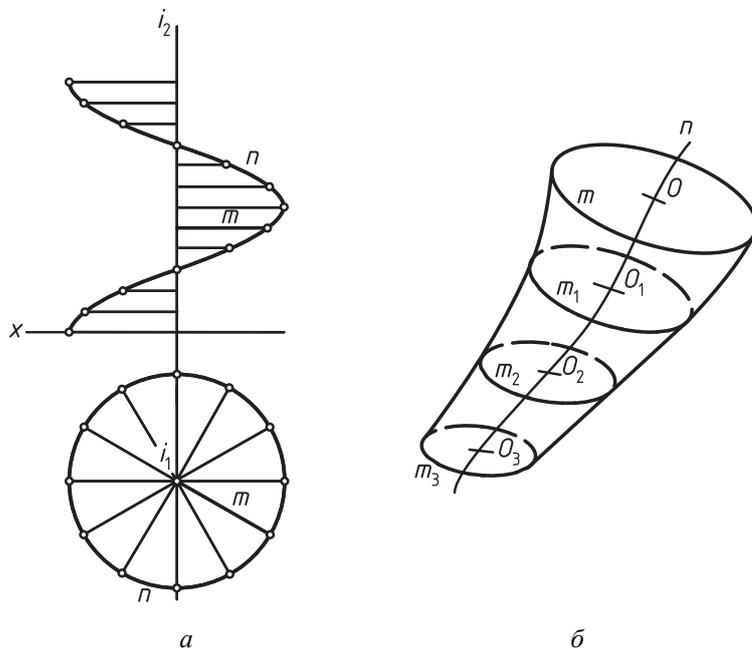
Рис. 74. Образование винтовой и циклической поверхностей
