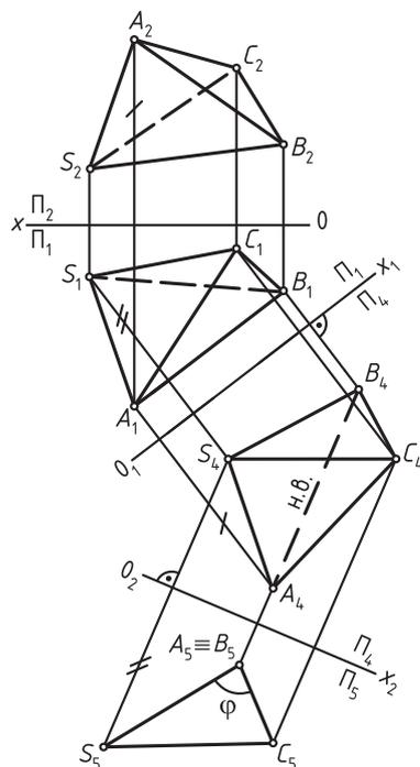
Рис. 44. Определение величины двугранного угла при ребре  $AB$  пирамиды  $ABCS$
