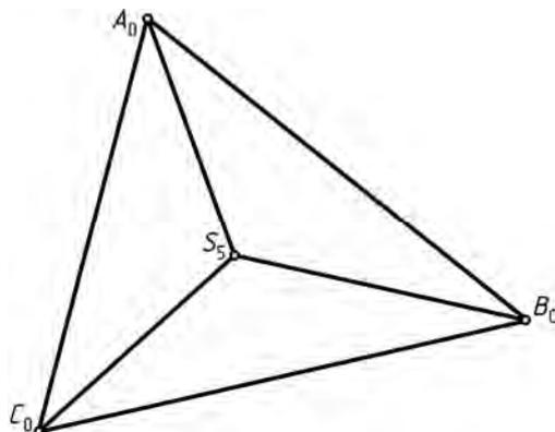
Рис. 129. Гранная поверхность в проекциях с числовыми отметками
