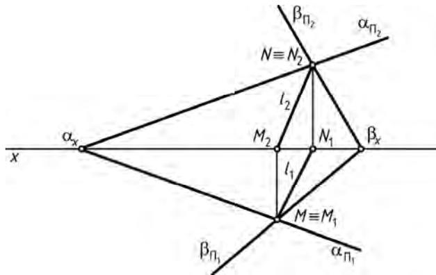
Рис. 34. Пересечение плоскостей общего положения, заданных следами
