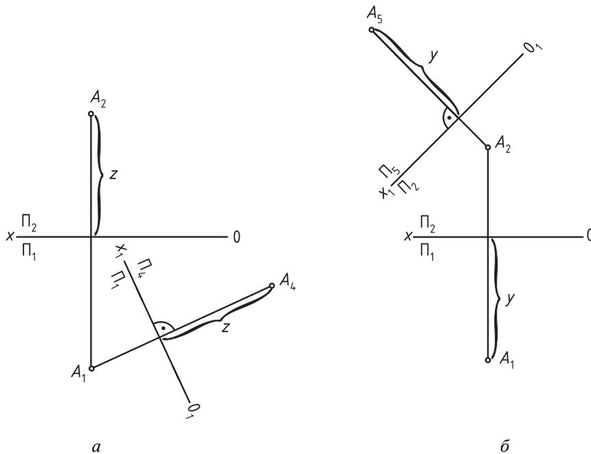
Рис. 38. Проекции точки в способе замены плоскостей проекций
