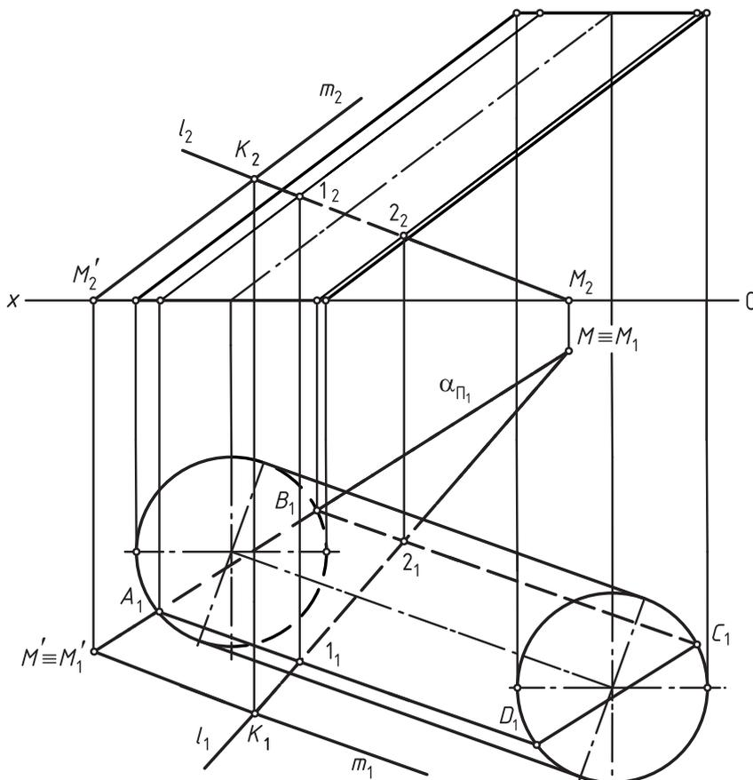
Рис. 111. Пересечение наклонного цилиндра прямой общего положения.
