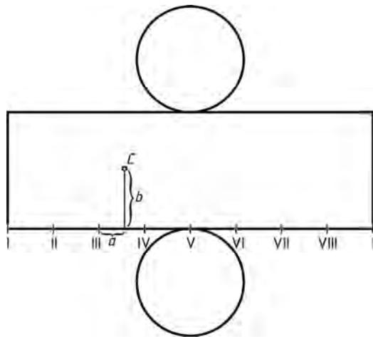
Рис. 67. Развертка прямого цилиндра
