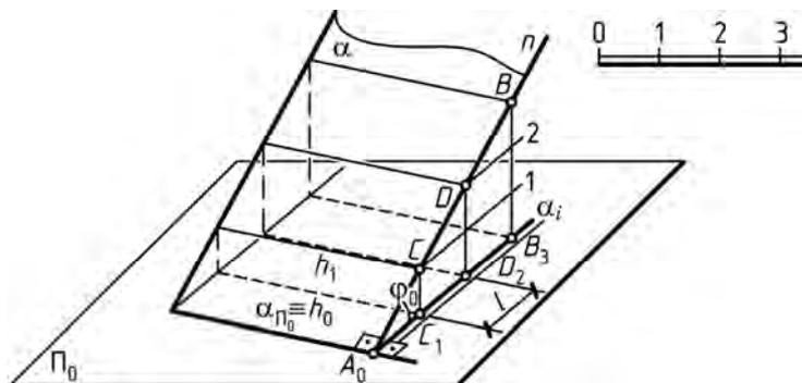
Рис. 125. Плоскость, заданная масштабом уклона
