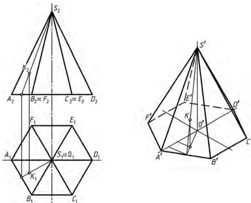
Рис. 151. Аксонометрическая проекция пирамиды
