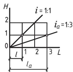
Рис. 137. Определение границы земляных работ для прямолинейного участка автомобильной дороги
