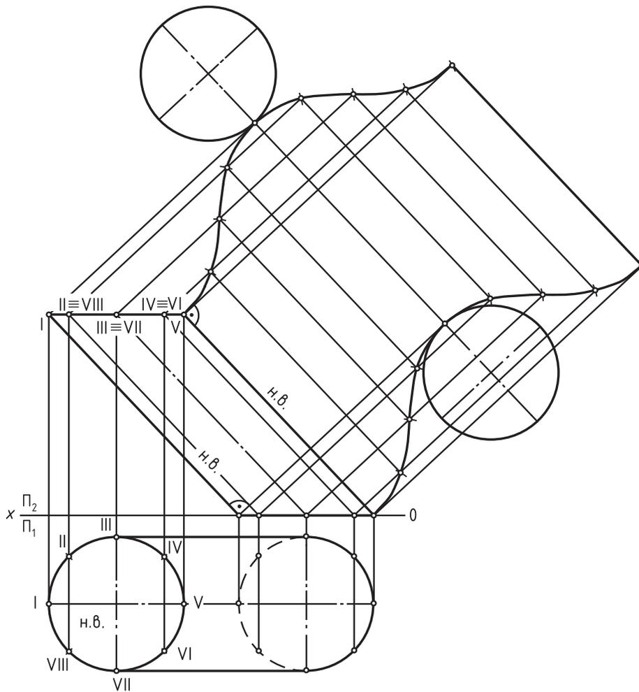
Рис. 86. Развертка наклонного цилиндра
