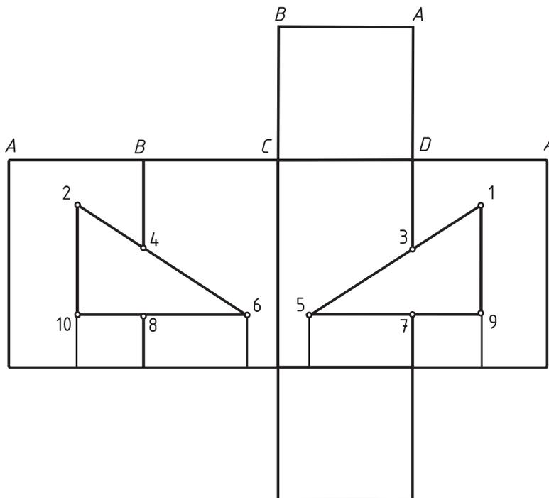
Рис. 76. Развертка прямой призмы с нанесением линии выреза
