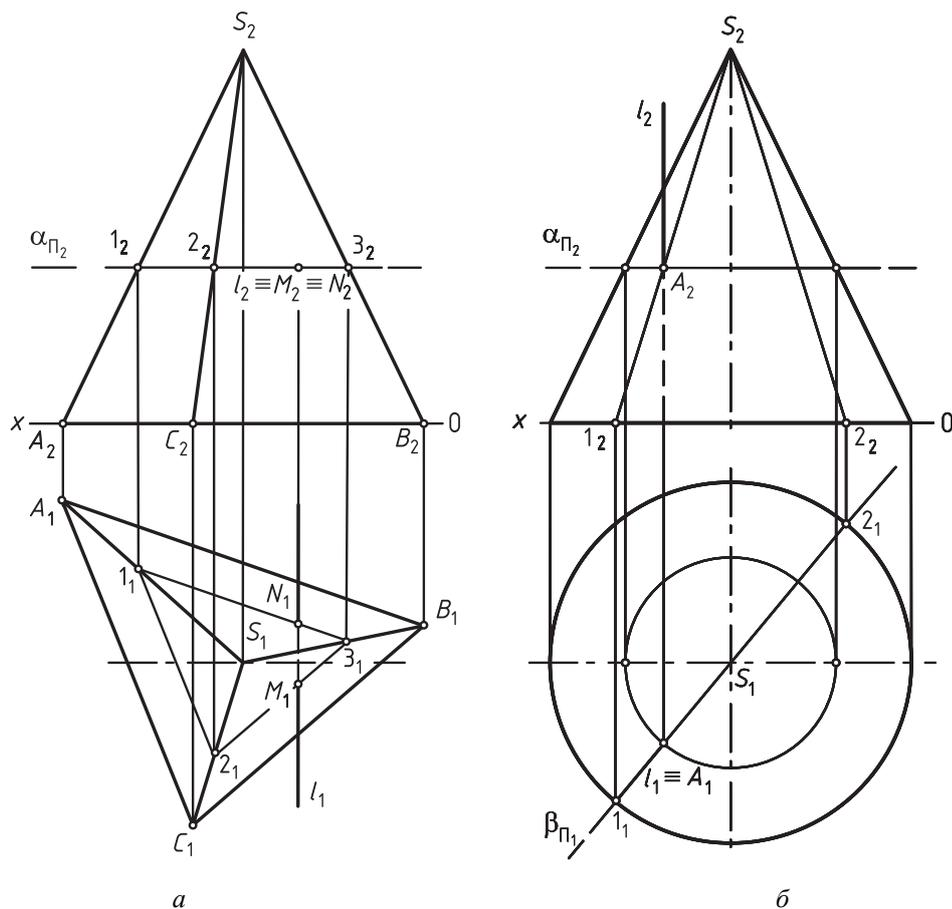
Рис. 107. Пересечение геометрических тел прямой частного положения
