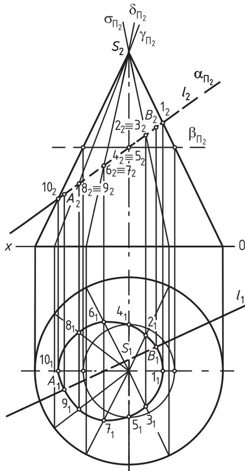
Рис. 106. Пересечение конуса прямой общего положения
