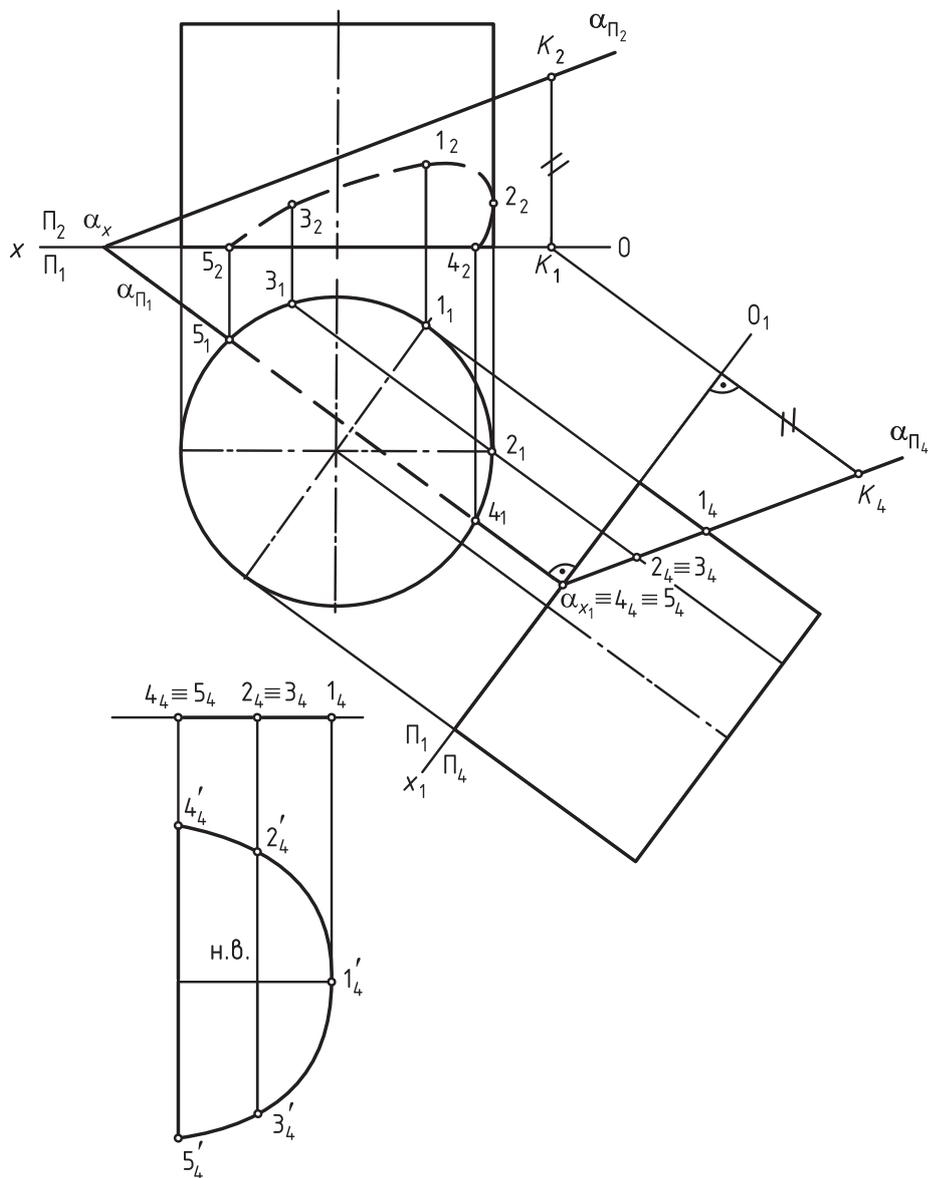
Рис. 102. Пересечение прямого цилиндра плоскостью общего положения
