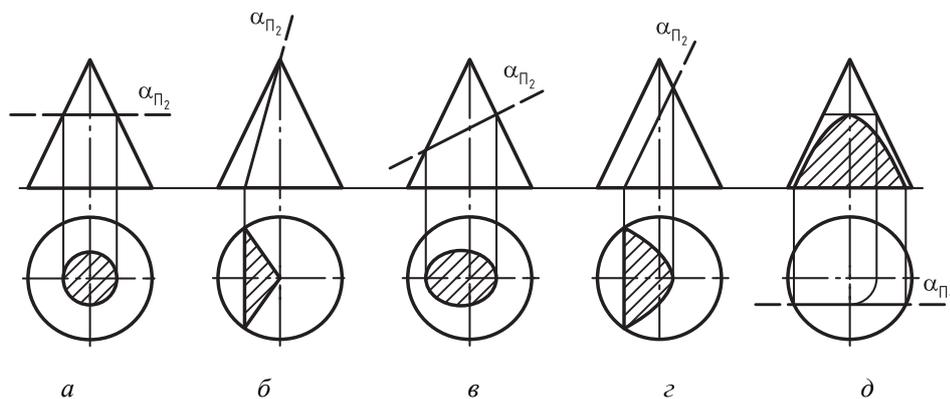
Рис. 94. Пересечение прямого конуса плоскостями частного положения
