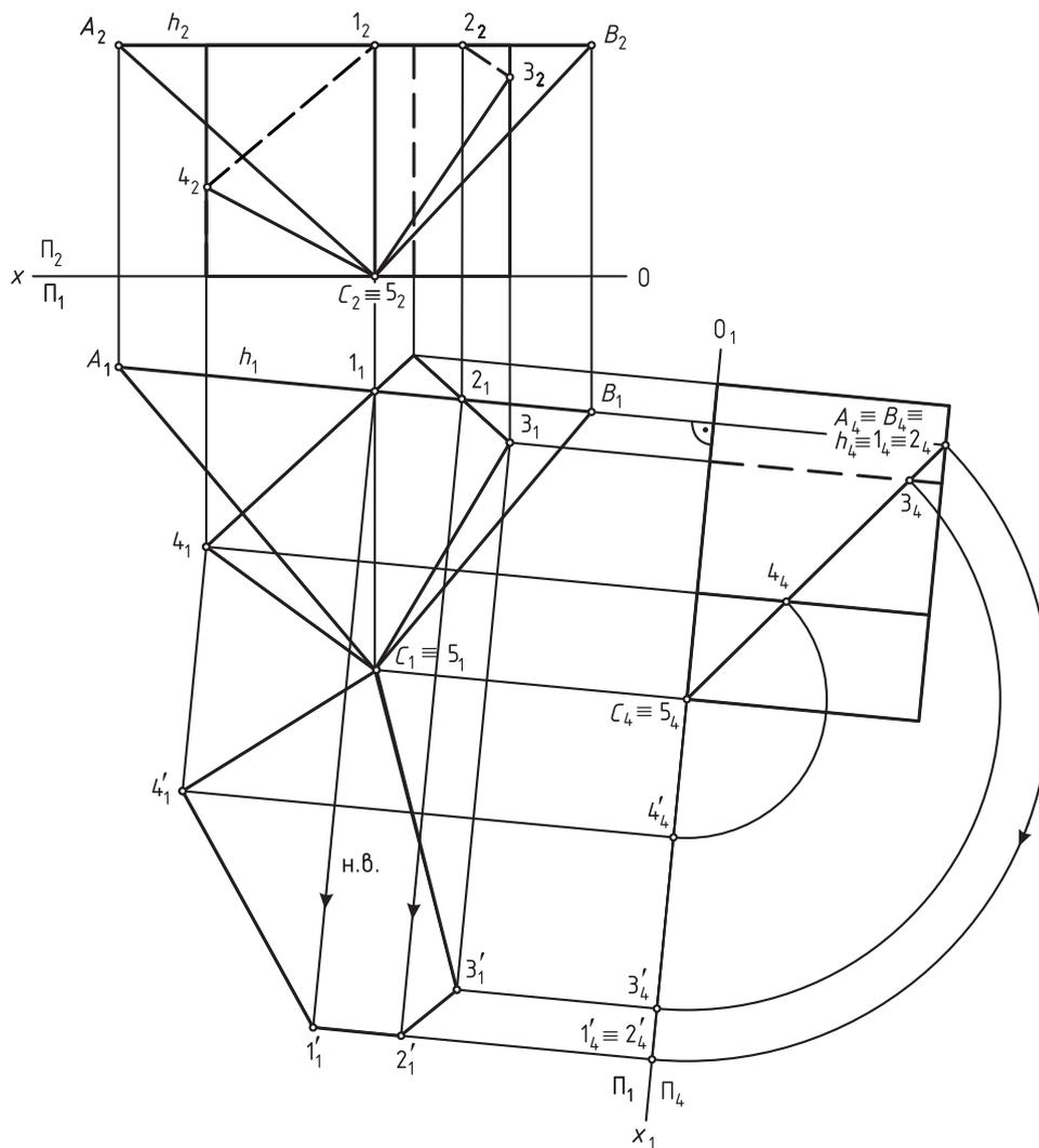
Рис. 100. Пересечение прямой призмы плоскостью общего положения  $\alpha$ , заданной  $\Delta ABC$
