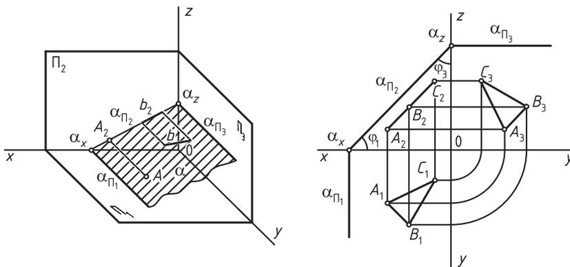
Рис. 25. Фронтально-проецирующая плоскость
