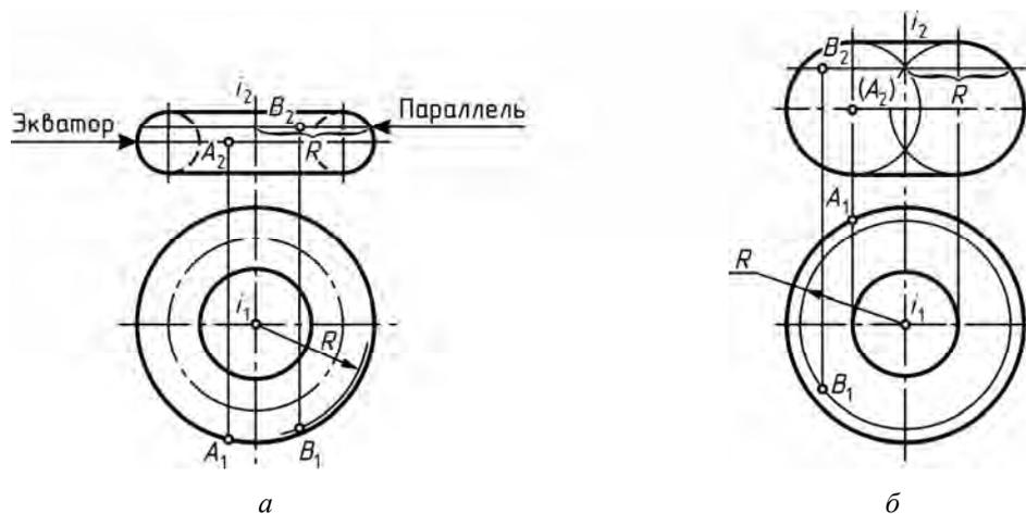
Рис. 73. Проекция точек на поверхности тора
