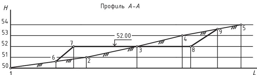
Рис. 139. Проектирование горизонтальной площадки на заданной высотной отметке и построение профиля топографической поверхности и сооружения
