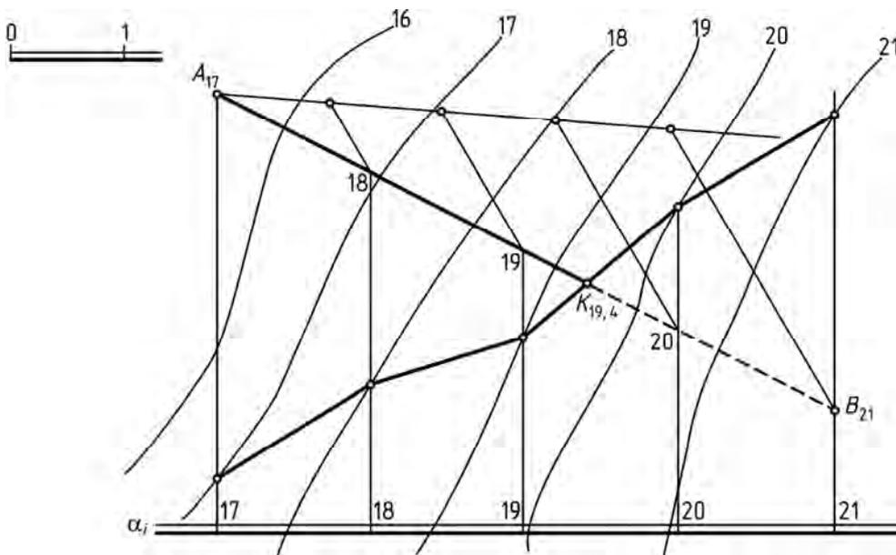
Рис. 135. Пересечение топографической поверхности прямой
