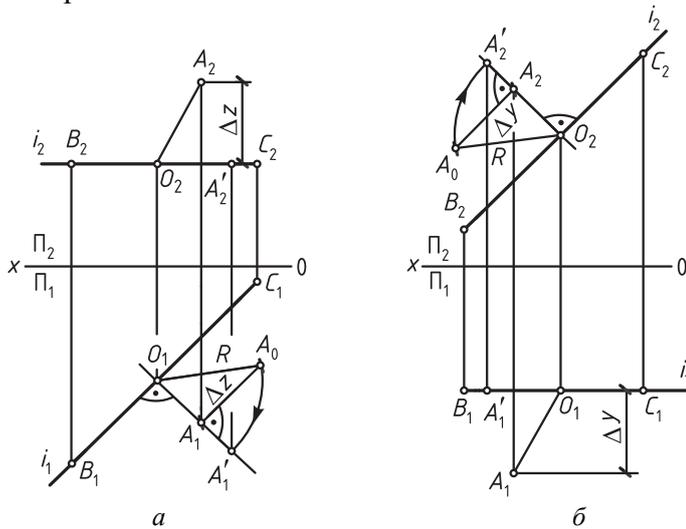
Рис. 53. Определение расстояния от точки до прямой
