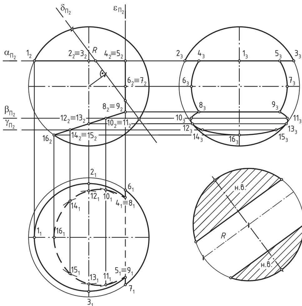
Рис. 83. Проекции сферы с вырезом
