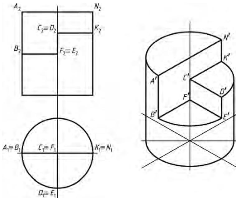
Рис. 153. Аксонометрическая проекция цилиндра с вырезами
