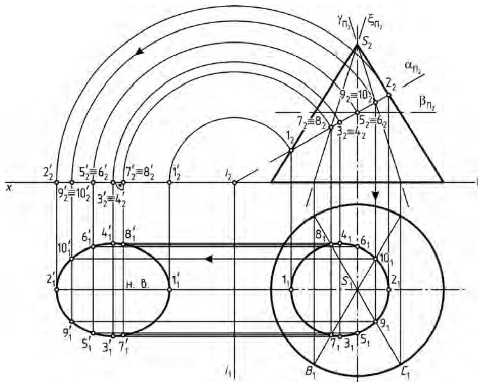
Рис. 96. Пересечение прямого конуса плоскостью частного положения
