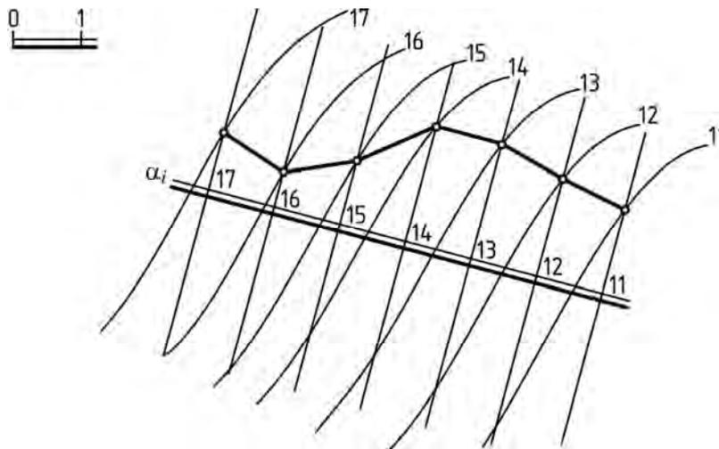
Рис. 134. Пересечение топографической поверхности плоскостью
