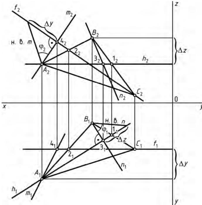
Рис. 30. Определение углов наклона плоскости к плоскостям проекций
