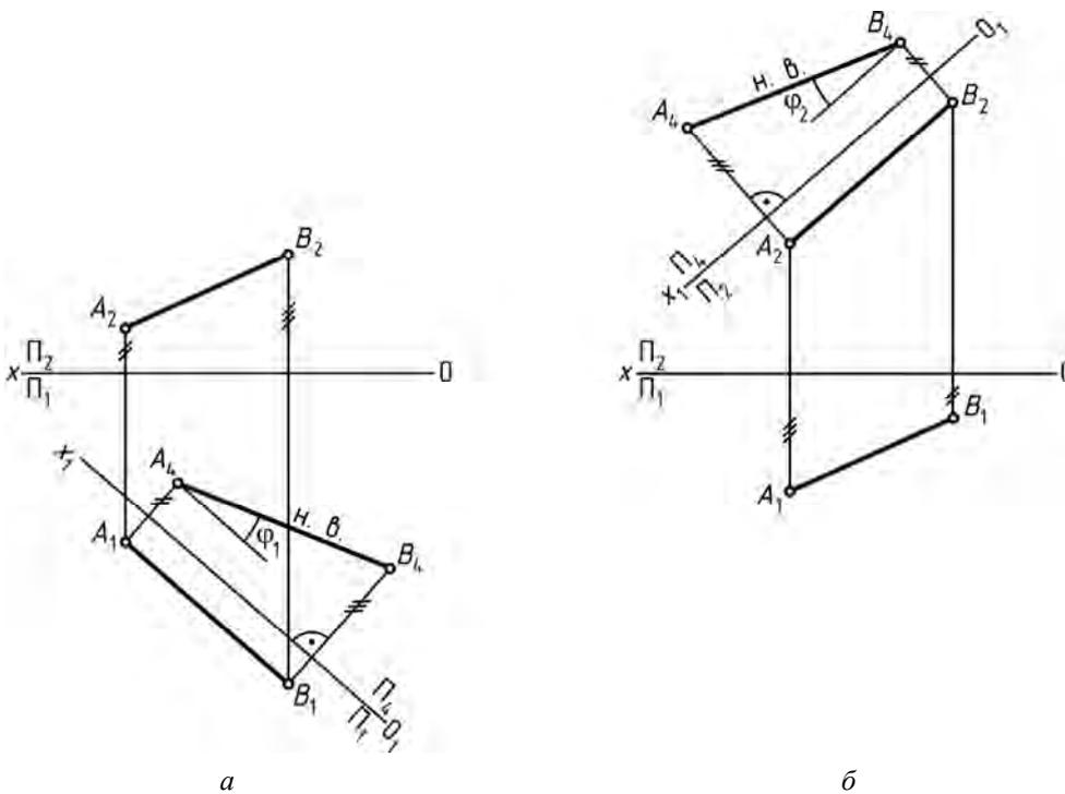
Рис. 39. Определение натуральной длины прямой
