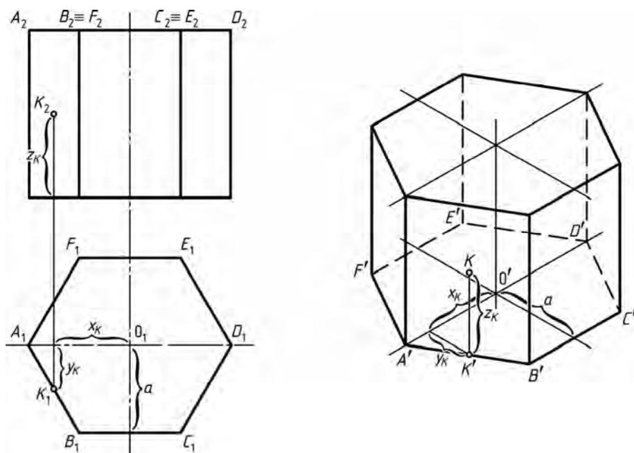
Рис. 150. Аксонометрическая проекция призмы
