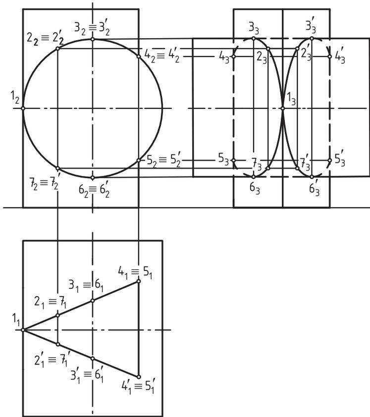
Рис. 115. Пересечение гранной поверхности и поверхности вращения
