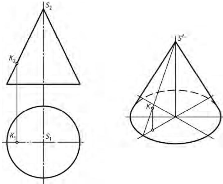
Рис. 152. Аксонометрическая проекция конуса
