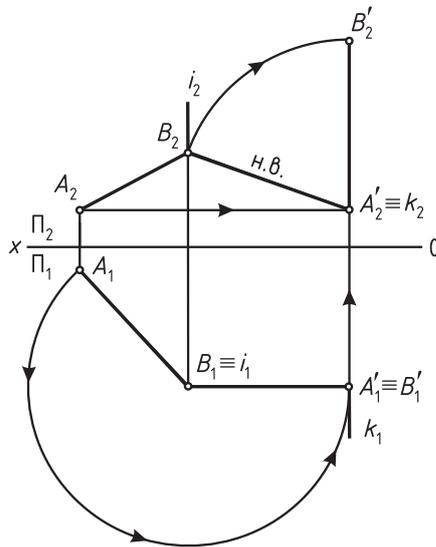
Рис. 47. Преобразование прямой  $AB$  из общего положения в проецирующее
