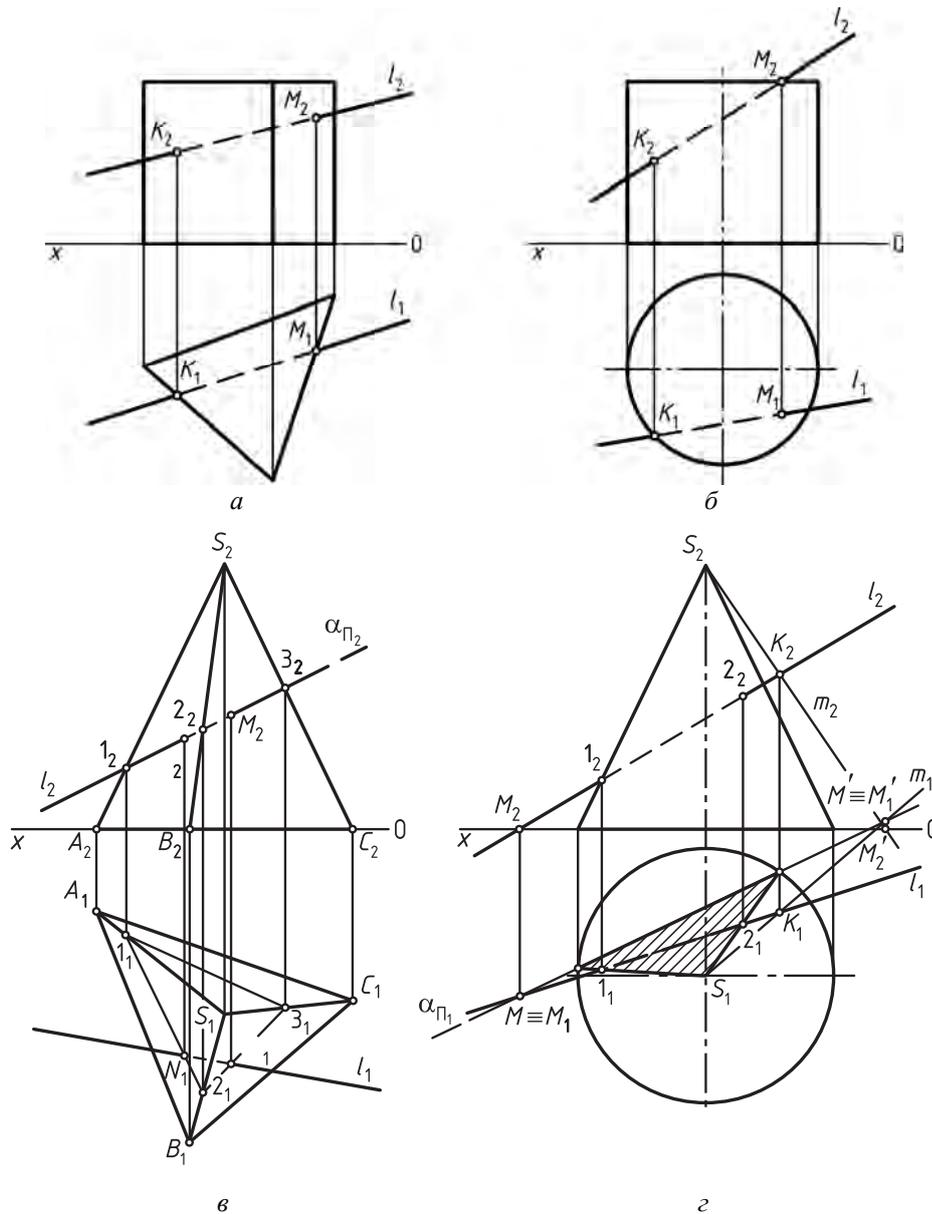
Рис. 105. Пересечение геометрических тел прямой общего положения
