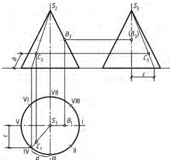
Рис. 68. Проекция точек на поверхности прямого конуса, получаемые с помощью образующей
