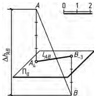
Рис. 119. Проекция отрезка прямой
