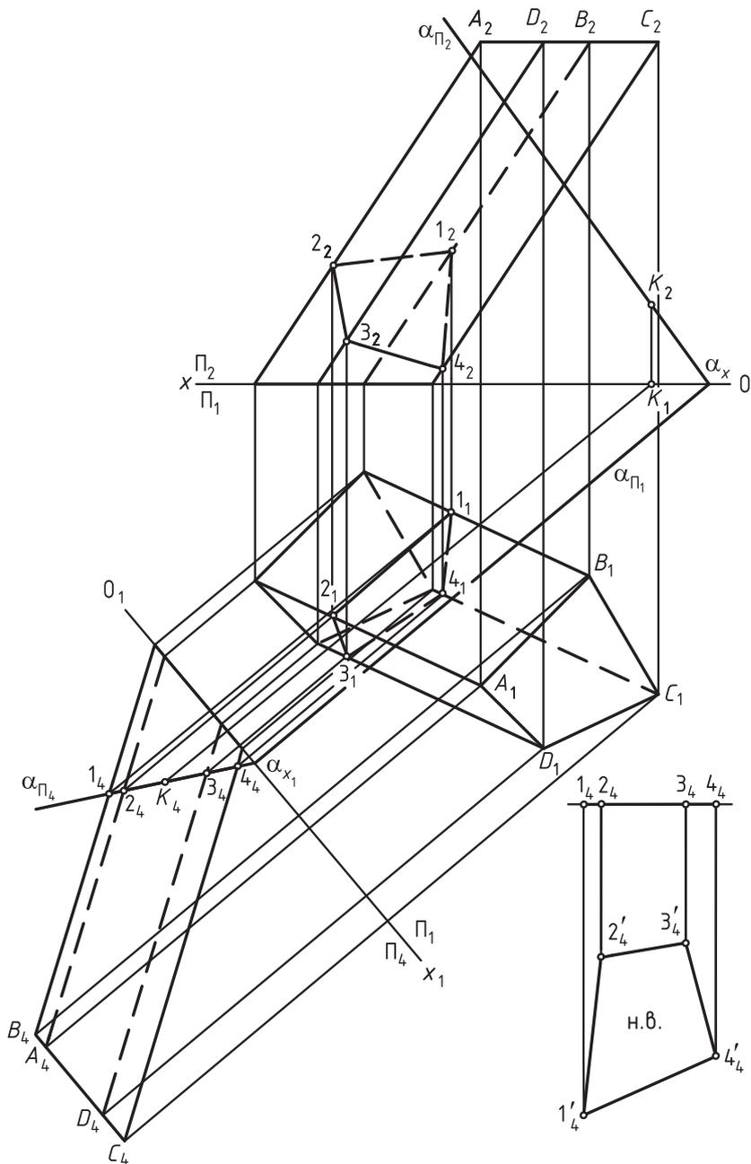
Рис. 101. Пересечение наклонной призмы плоскостью общего положения  $\alpha$ , заданной следами
