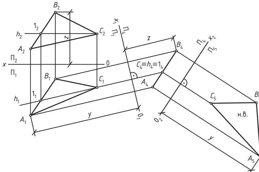
Рис. 41. Определение натуральной величины плоскости  $\alpha$  ( $\triangle ABC$ )
