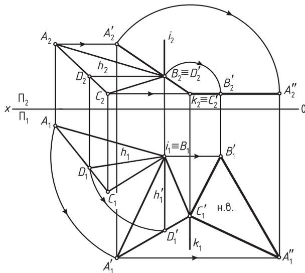
Рис. 50. Определение натуральной величины плоскости  $\Delta ABC$  (вариант 3)
