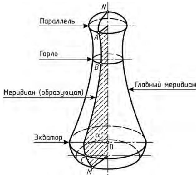
Рис. 65. Образование поверхности вращения
