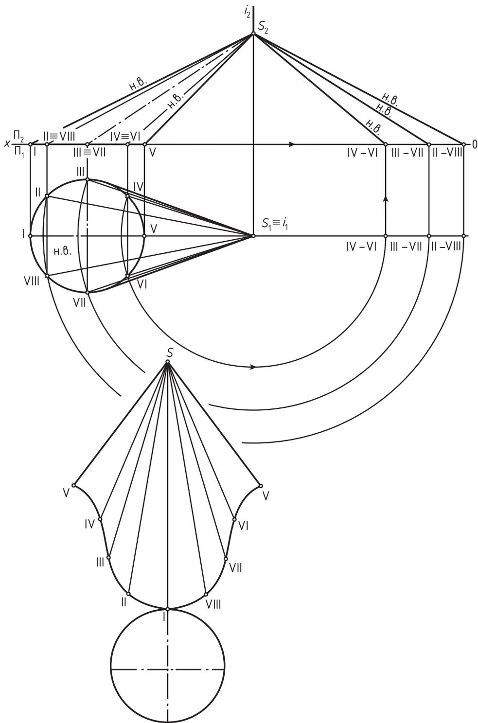
Рис. 87. Развертка наклонного конуса
