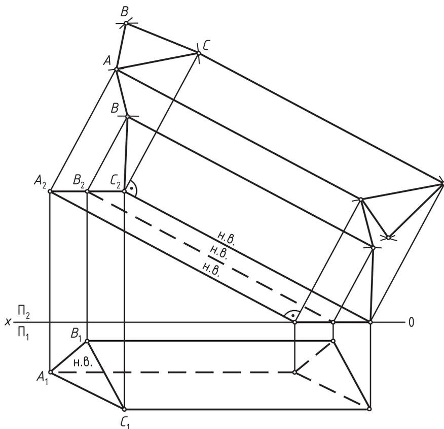
Рис. 84. Развертка наклонной призмы
