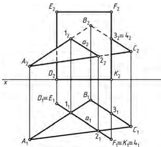
Рис. 32. Пересечение плоскостей общего и частного положения
