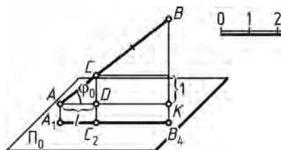
Рис. 120. Уклон и интервал отрезка прямой
