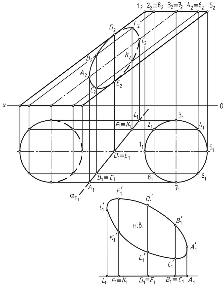
Рис. 97. Пересечение наклонного цилиндра плоскостью частного положения
