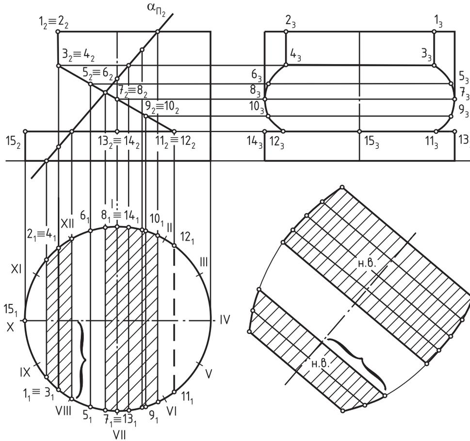
Рис. 79. Проекция прямого цилиндра с вырезом и натуральная величина сечения цилиндра плоскостью  $\alpha$
