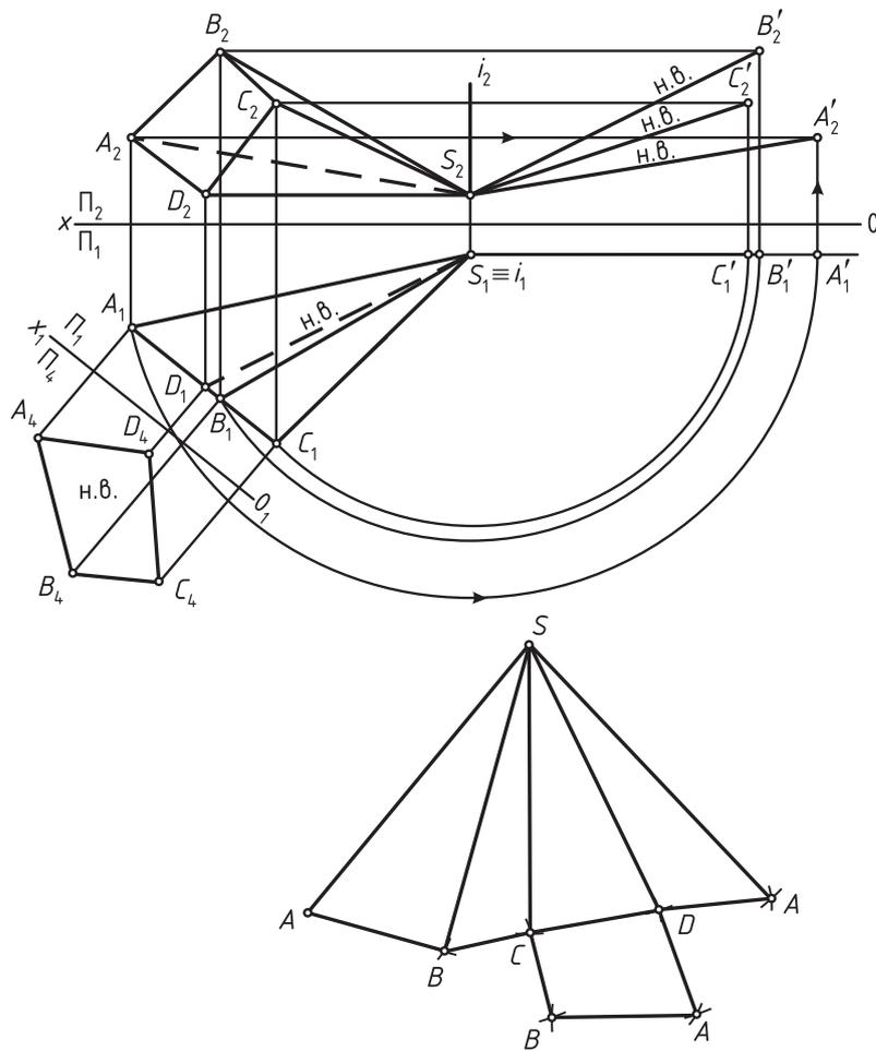
Рис. 85. Развертка наклонной пирамиды
