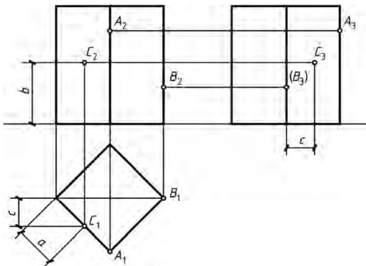
Рис. 60. Проекции точек на поверхности прямой призмы
