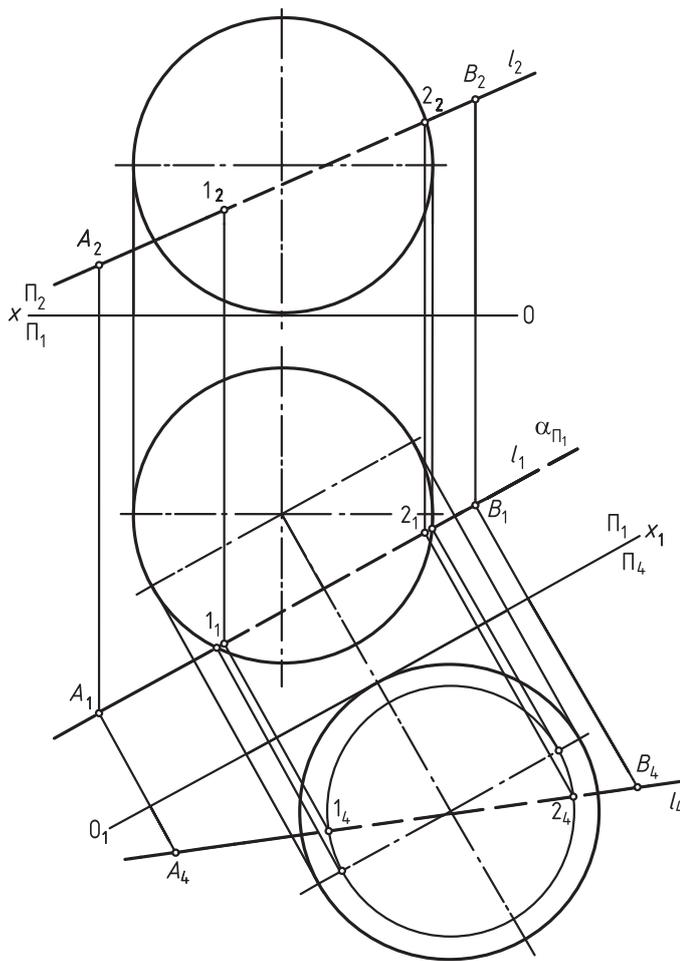
Рис. 108. Пересечение сферы прямой общего положения способом замены плоскостей проекций
