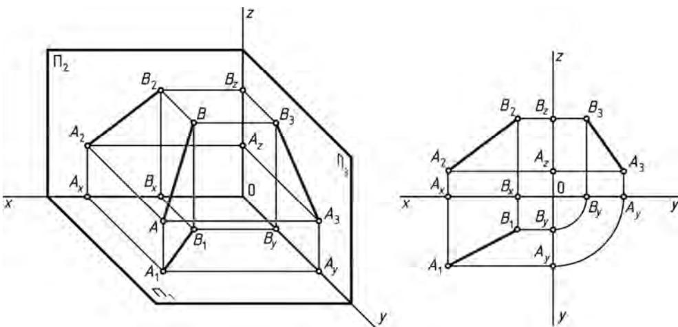
Рис. 10. Проекция прямой линии
