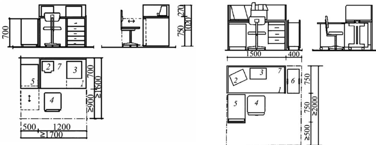
Рис. 5.9. Рабочее место сотрудника кассы пересчета банкнот (два варианта): 1 — стол кассовый для пересчета; 2 — машина для счета банкнот; 3 — машина для обандероливания; 4 — стул рабочий подъемно-поворотный; 5 — закрытая тележка (передвижной сейф) для транспортировки денег; 6 — контейнер для мусора; 7 — ограждение из матового стекла
