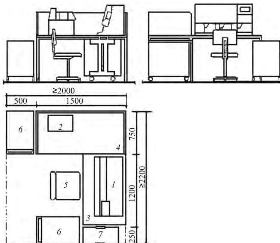
Рис. 5.10. Рабочее место оператора машины для пересчета и сортировки банкнот: 1 — машина для пересчета и сортировки денег типа DLR 3700; 2 — машина для обандероливания; 3 — стол рабочий 120×75×75 см; 4 — стол рабочий 150×75×75 см; 5 — стул рабочий подъемно-поворотный; 6 — закрытая тележка (передвижной сейф) для транспортировки денег; 7 — контейнер для мусора
