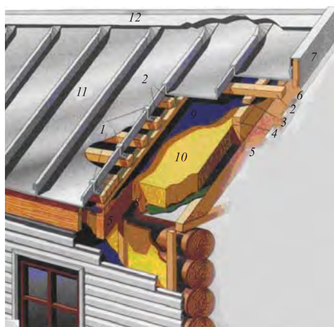
Рис. 48. Устройство теплой стальной кровли: 1 — кляммер с гвоздем; 2 — обрешетка (брус 50×50 мм); 3 — контрообрешетка ( рейка 25×50 мм); 4 — повысительный брус (50×50 мм); 5 — стропило (200×50 мм); 6 — торцевая доска (100×25 мм.); 7 — торцевая планка; 8 — пароизоляция; 9 — гидроизоляция; 10 — утеплитель — 150 мм; 11 — фальцевый лист; 12 — коньковая планка
