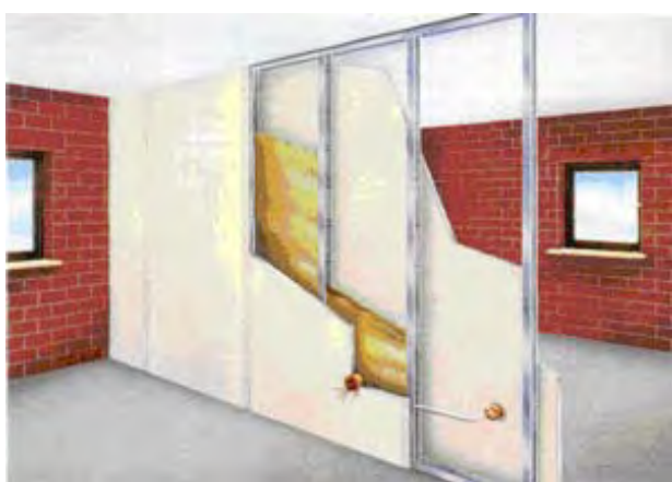
Рис. 57. Перегородка из гипсокартона: а — вид; б — фрагмент: 1 — листы ГКЛ (гипсокартонные листы); 2 — каркас из металлического профиля; 3 — изоляционный материал «Технолайт»; 4 — отделочный материал
