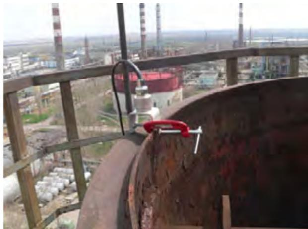
Рисунок 2 - Крепление вибродатчика (акселерометра) на обресе дымовой трубы на отметке +49,500.
