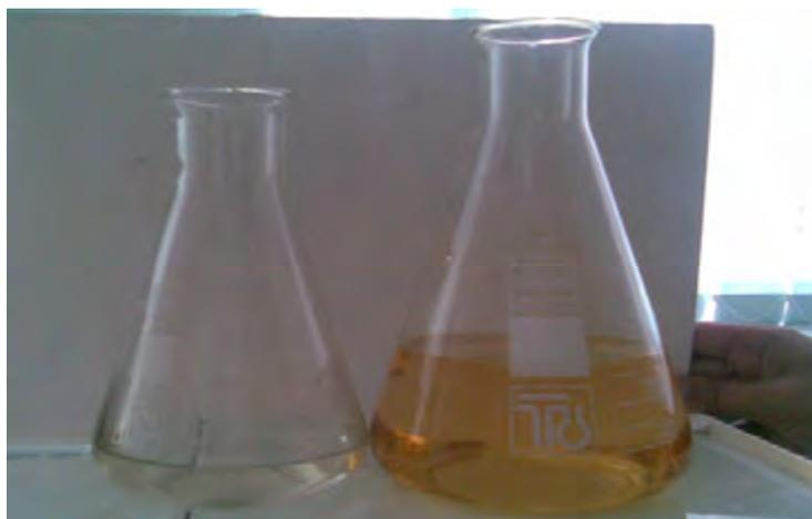
Рисунок 4 - Визуальные результаты очистки: наглядное сравнение растворов до и после очистки: исходная концентрация  $\text{Fe}^{3+} = 100$  мг/л, расход сорбционного материала 3 г/л, размер частиц материала – 5 – 7 мм, рН среды – 7,5.
