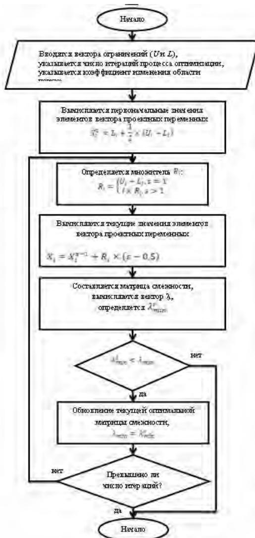
Рисунок 6 - Блок-схема алгоритма оптимизации весов дуг орграфа
