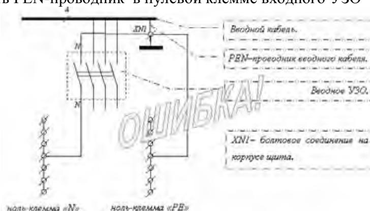
Рисунок 6 - Ввод PEN-проводника во входную клемму "N" УЗО – ОШИБКА!
