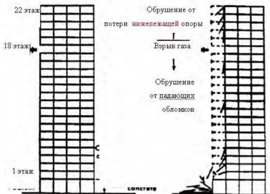
Рисунок 1 – Ситуация, послужившая толчком к возникновению темы и одноименного теме термина «прогрессирующее» обрушение.
