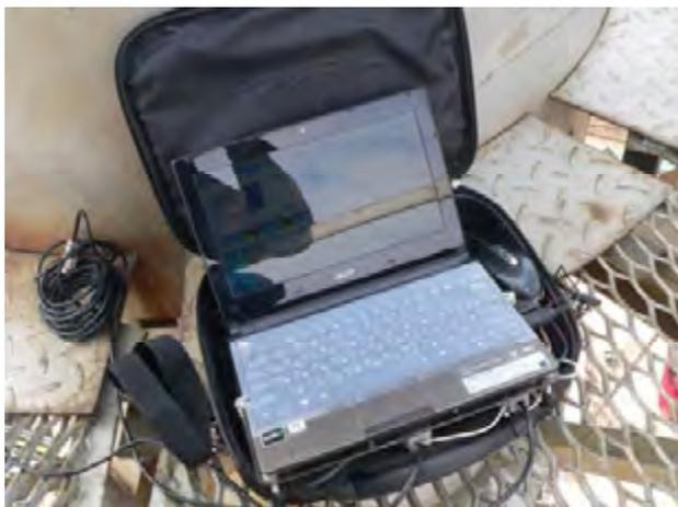
Рисунок 1 - Портативный комплекс для измерения параметров колебаний строительных конструкций.
