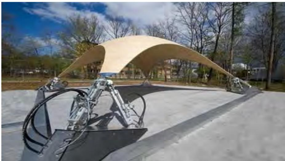
Рисунок 3 – Демонстрационный вариант навесной крыши, закрепленной в четырех точках, в трех из которых установлены гидроприводы [6].
