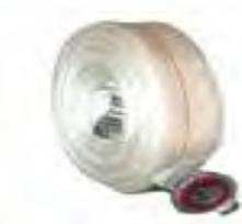
Рукава пожарные напорные модели «Универсал» используются для оснащения внутренних пожарных кранов и мобильных мотопомп. Принцип действия рукава заключается в подаче огнетушащих растворов на расстояние под высоким давлением (рабочее давление до 1,0 МПа). Температурный интервал использования рукавов «Универсал» - от -60 градусов до +40 градусов Цельсия в условиях умеренно-холодного климата.
