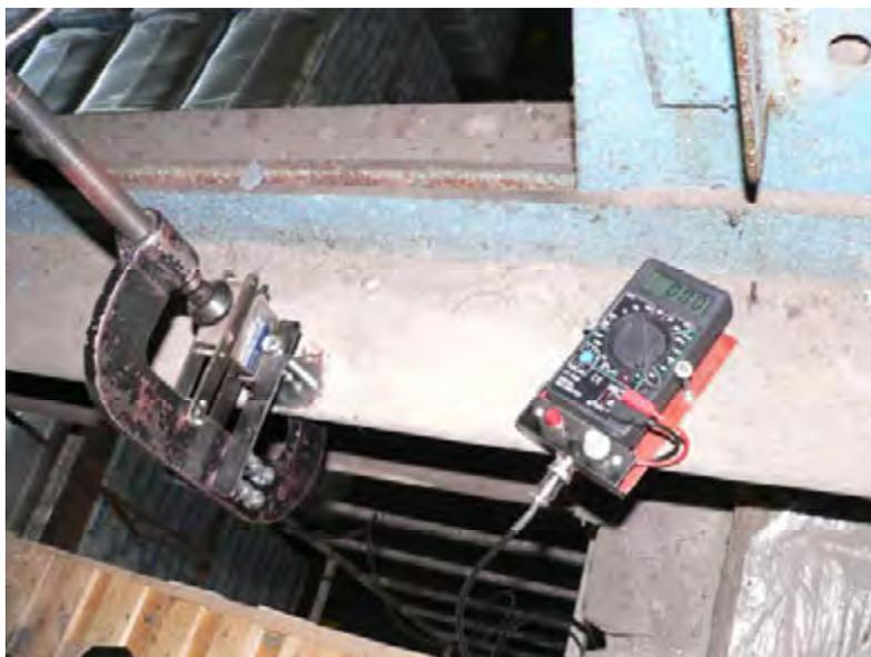
Рисунок 1 - Испытание элемента нижнего пояса стропильной фермы
