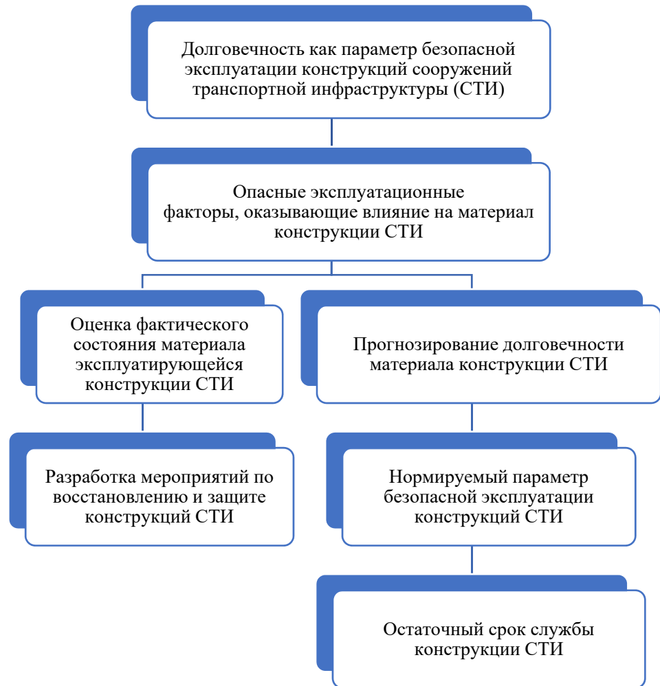
Рис. 1. Основные этапы реализации программы по безопасной эксплуатации (ТС)
