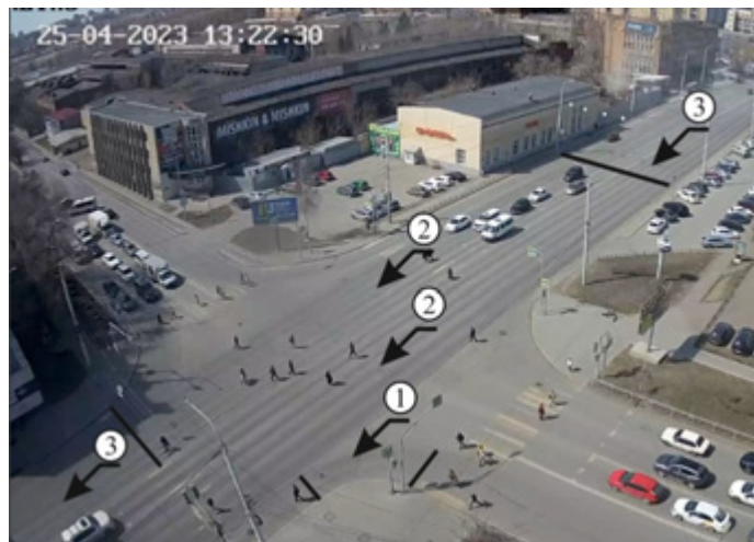
Рис. 2. Схема учета интенсивности движения на характерных участках образования колеи износа, расположенных на пересечении улиц Красный путь и Кемеровская в Омске: 1 — участок поворота автомобилей по кривой малого радиуса; 2 — участки торможения вплоть до полной остановки автомобиля с последующим стартом с места и набором скорости до 20 км/ч; 3 — участок разгона от 20 до 60 (80) км/ч
