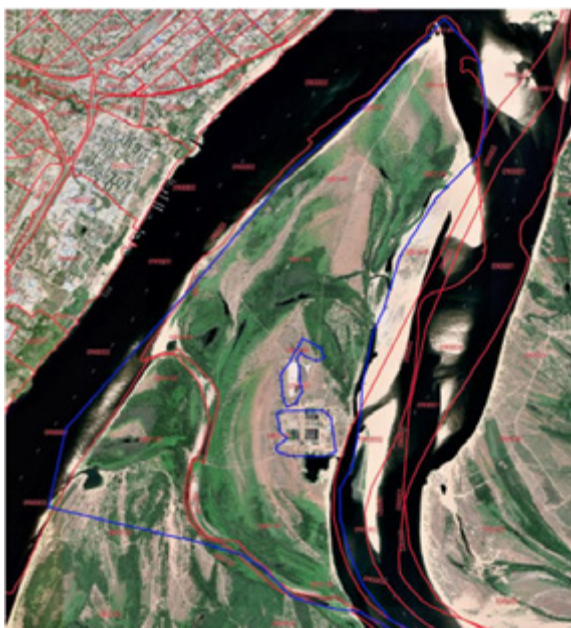
Рис. 1. Границы затопления о. Голодный. Синим цветом выделена граница зоны затопления, красным цветом — граница кадастрового квартала
