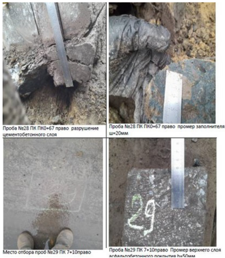
Рис. 2. Результаты вскрытия дорожной одежды
