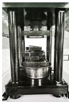
Рис. 7. Испытания элемента на поперечный изгиб
