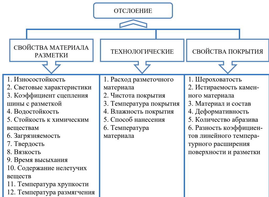
Рис. 2. Причины отслоения материала
