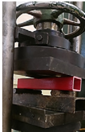
Рис. 6. Испытания элемента на сжатие
