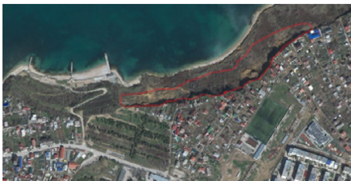
Рис. 2. Карта-схема оползня Учкучевский. Красным контуром выделено тело оползня
