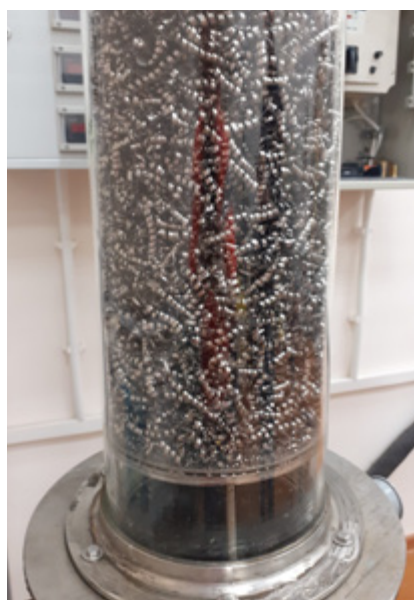
Рис. 1. Экспериментальный модуль с исследуемым насадочным материалом S-VT5 ε-0,85
