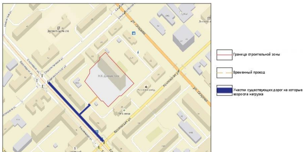
Рис. 1. Строительство жилого объекта в существующей застройке
