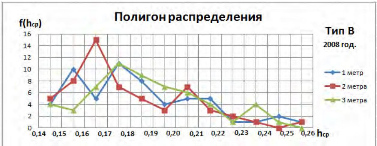
Рис.10. - Полигон распределения показателей шероховатости построенный для типа В асфальтобетона на расстояниях 1, 2 и 3 метра от кромки покрытия.
