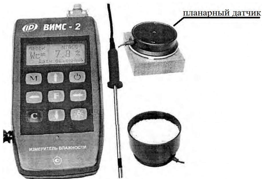
Рис.4. - Общий вид электроемкостного прибора ВИМС-2.21.
