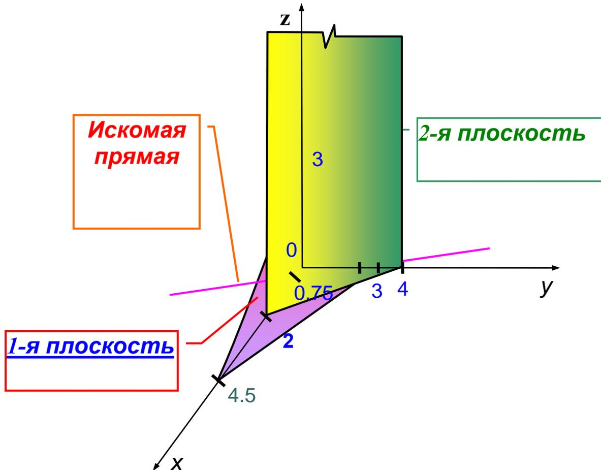
Для построения проекции прямой достаточно найти любые две ее точки. Проще всего выбрать точки пересечения прямой с координатными плоскостями. Например, точку пересечения с плоскостью  $XOY$  получим из уравнений прямой, полагая  $z = 0$ , получим систему двух уравнений, решив которую получим искомые точки прямой.
