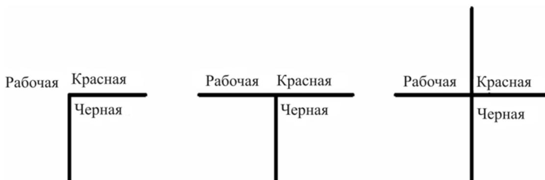
Рис. 17. Схема записи отметок в углах планировочной сетки
