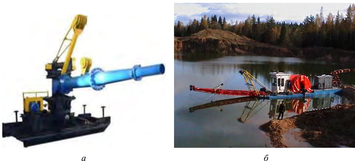
Рис. 37. Разработка и перемещение грунта: *а* — гидромониторами; *б* — плавучим землесосным снарядом
