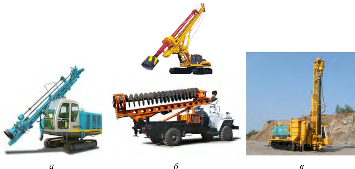
Рис. 41. Механическое бурение грунта: *а* — ударным методом (буровая установка ударно-канатного бурения); *б* — вращательным методом (установки вращательного бурения); *в* — ударно-вращательным методом (буровой станок ударно-вращательного бурения)
