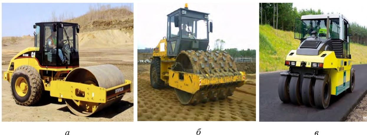
Рис. 34. Уплотнение грунта катками: *а* — гладкими; *б* — кулачковыми; *в* — пневмошинными
