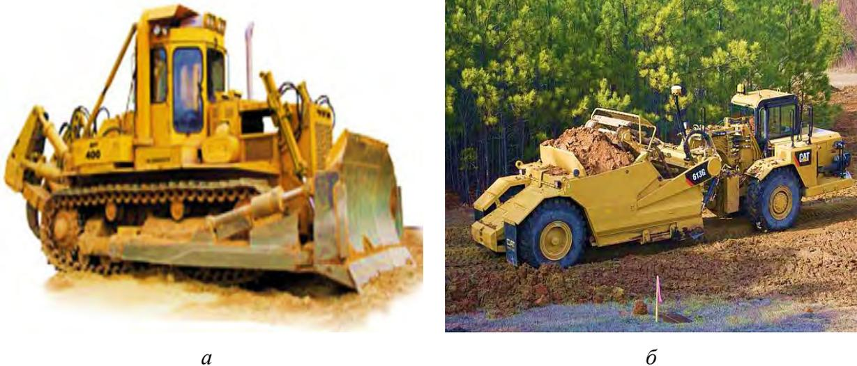
Рис. 32. Разработка грунта: *а* — бульдозером; *б* — скрепером
