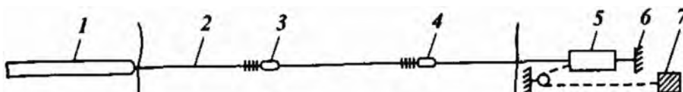
Рис. 15. Схема протаскивания трубопровода с периодическим сматыванием троса с барабана дополнительной тяговой лебедки: 1 — трубопровод; 2 — тяговый трос; 3, 4 — соединительные звенья тросов; 5 — тяговая лебедка; 6 — якорная опора; 7 — дополнительная лебедка
