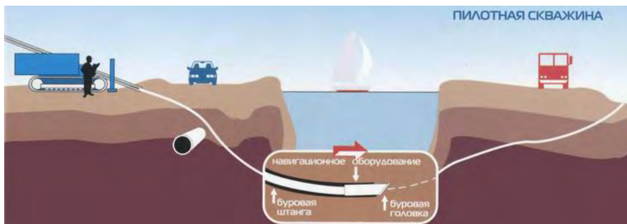
Рис. 39. Бурение пилотной скважины методом ГНБ
