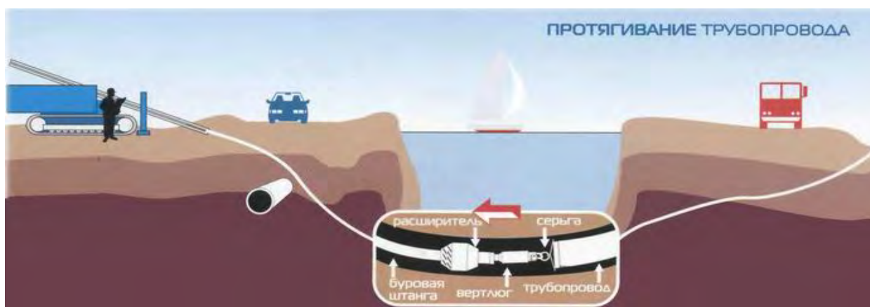
Рис. 41. Протягивание трубопровода в скважину
