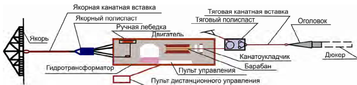
Рис. 24. Примерная схема работы лебедки ЛП152 с полиспастом усилием 300 т
