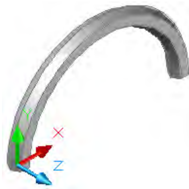
Рис. 57. Экструзия вдоль траектории
