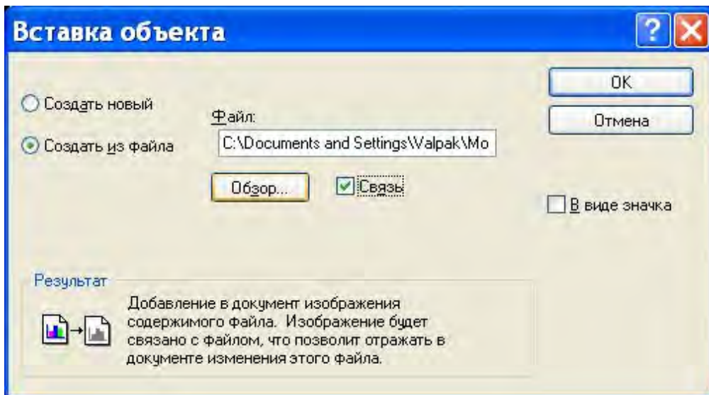
Рис. 30. Вставка связанного объекта по команде Insert — OLE Object
