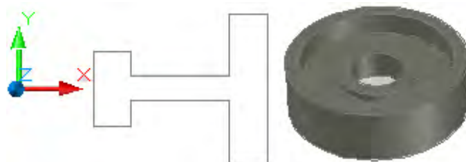
Рис. 61. Построение объектов с помощью команды Revolve
