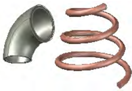
Рис. 60. Построение объектов с помощью команды Sweep
