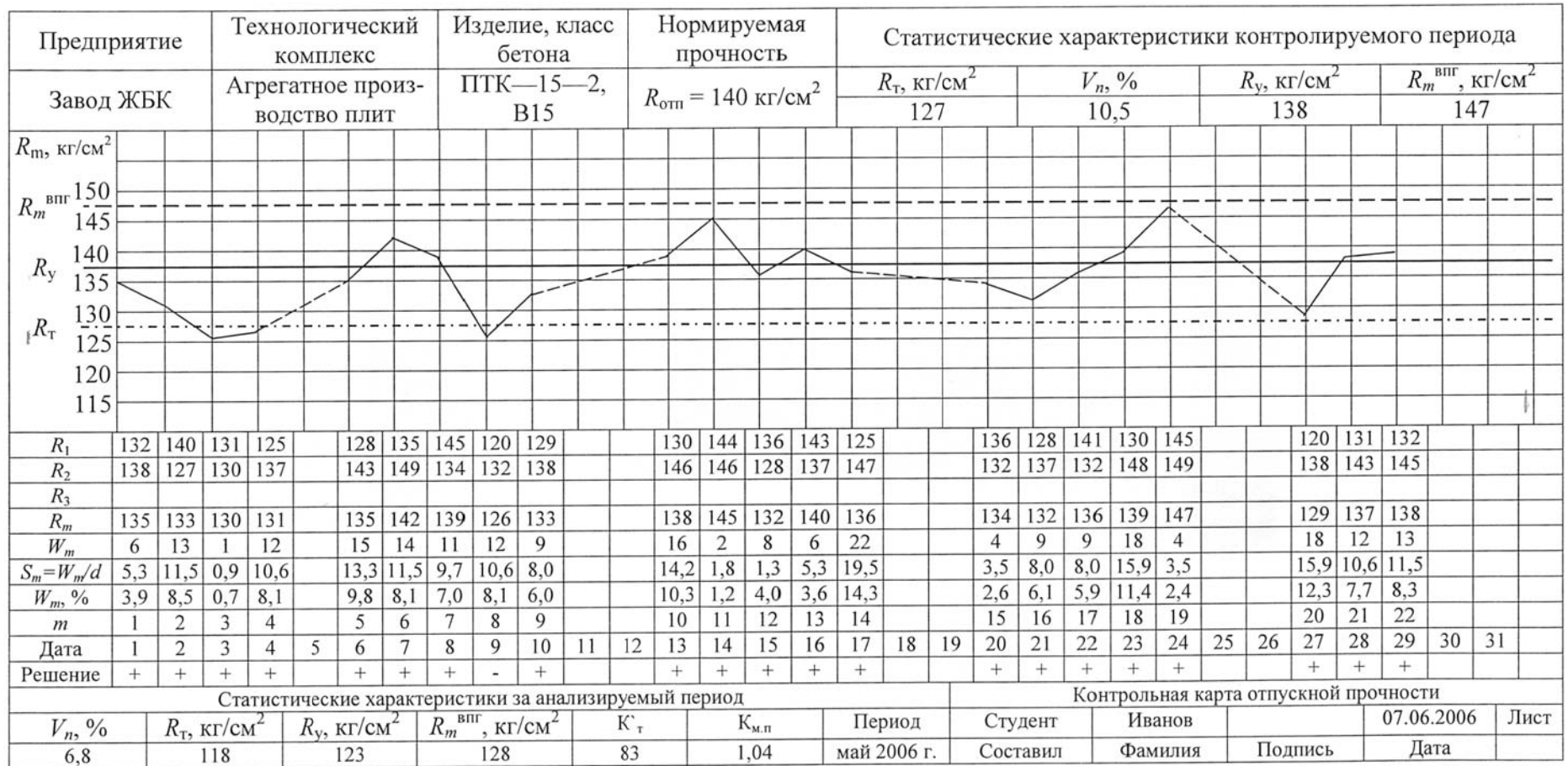
Рис. 1. Контрольная карта отпускной прочности бетона
