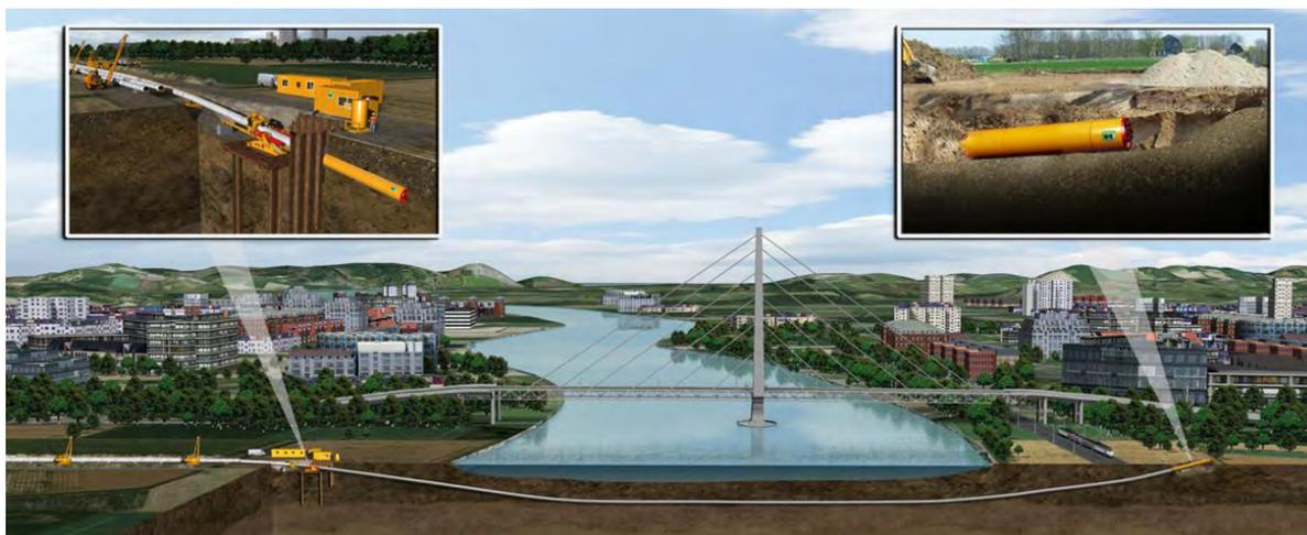
Рис. 3. Пример работы бестраншейной установки при прокладке тоннеля под рекой в черте города
