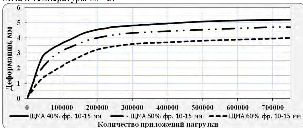
Рис. 2. Характер зависимостей остаточных деформаций щебеночно-мастичного асфальтобетона от 750 000 приложений расчетной нагрузки при варьировании содержания крупных фракций щебня
