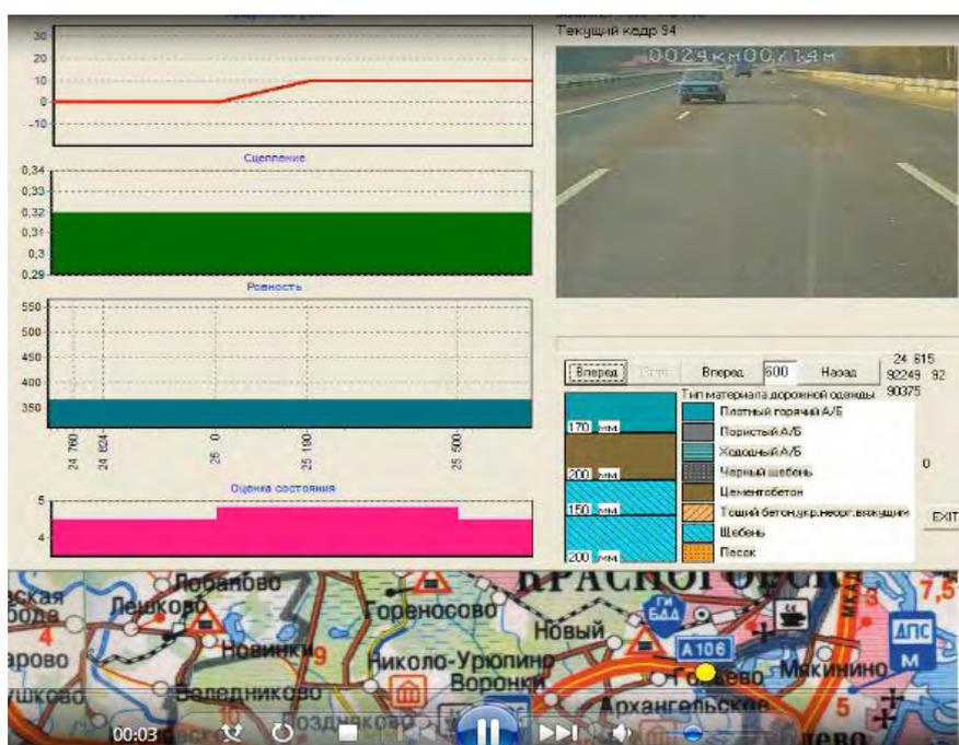
Рис. 4. Пример представления участка автомобильной дороги в системе АБДД «Дорога»
