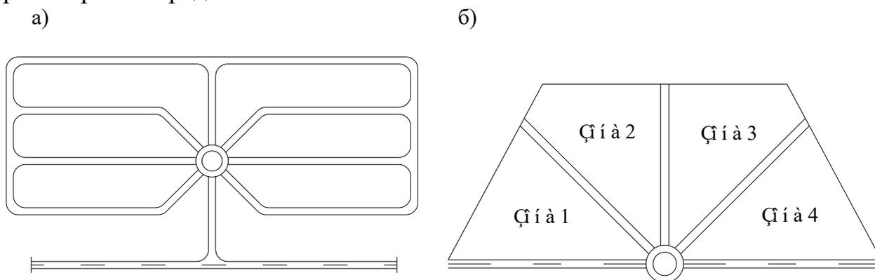
Рис. 2. Схемы парковочных площадок с применением малых кольцевых пересечений
