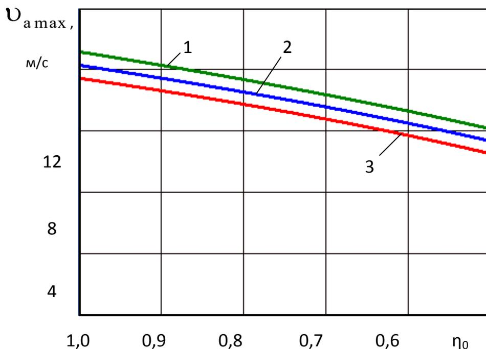
Рис. 2. Зависимость критической скорости от коэффициента устойчивости автобуса при различных значениях угла наклона дороги 1 – 0°; 2 – 3°; 3 – 6°
