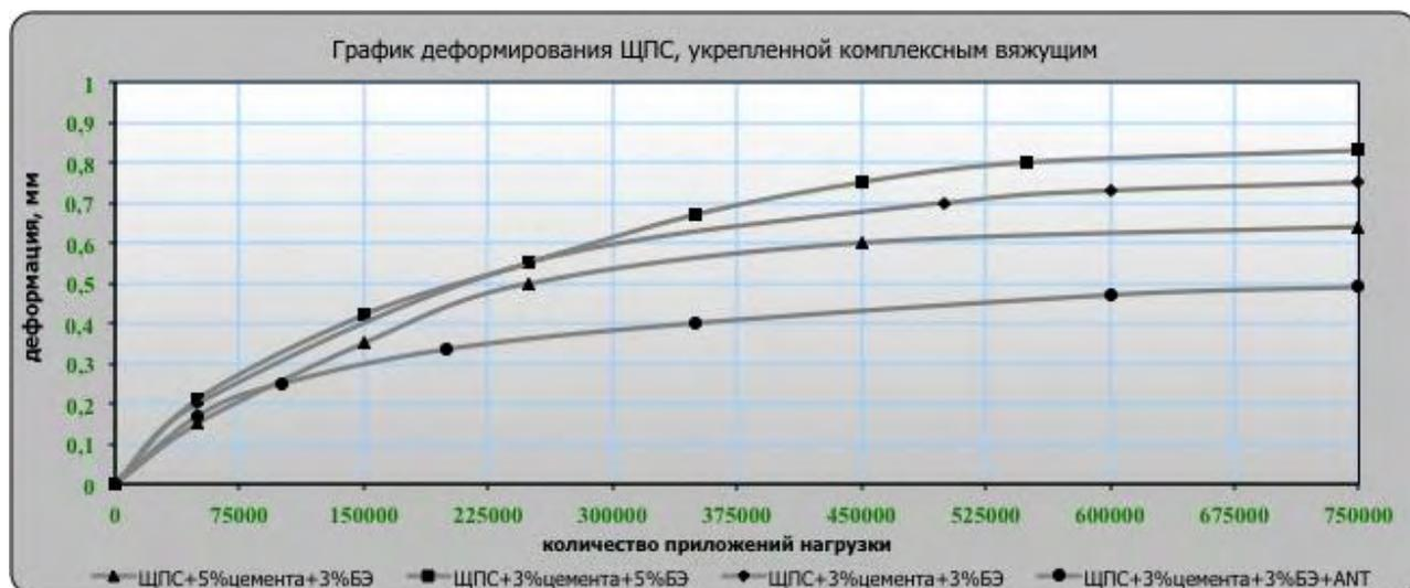
Рис. 3. График испытаний устойчивости щебеночно-песчаных смесей, укрепленных комплексным вяжущим к накоплению остаточных деформаций
