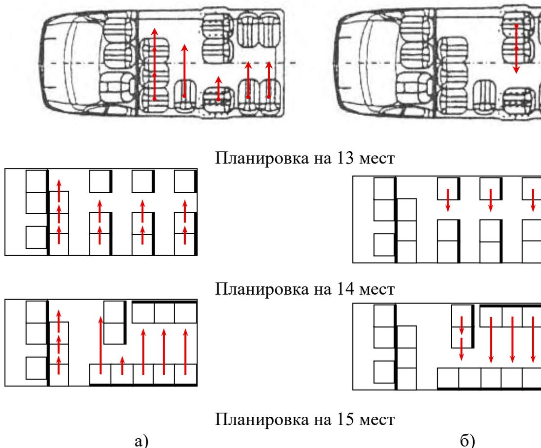
Рис. 1. Схемы возможных перемещений пассажиров по инерции на поворотах в салоне микроавтобусов «ГАЗель» с различной планировкой: а) на левом повороте; б) на правом повороте
