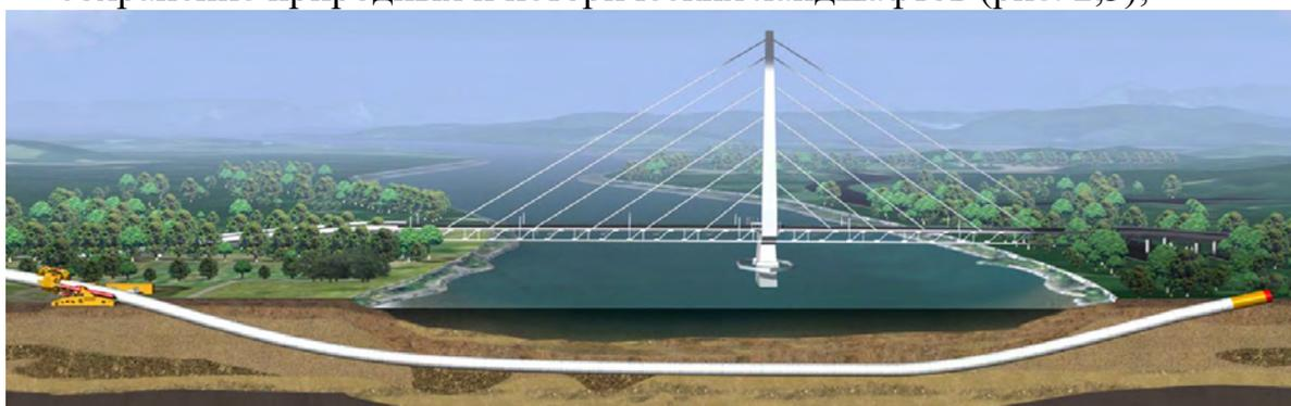
Рис. 2. Пример работы бестраншейной установки при прокладке тоннеля под рекой за пределами города
