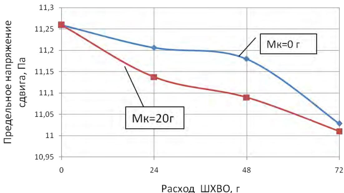
Рис. 2. Предельное напряжение сдвига цементного теста ( $\tau_0$ )
