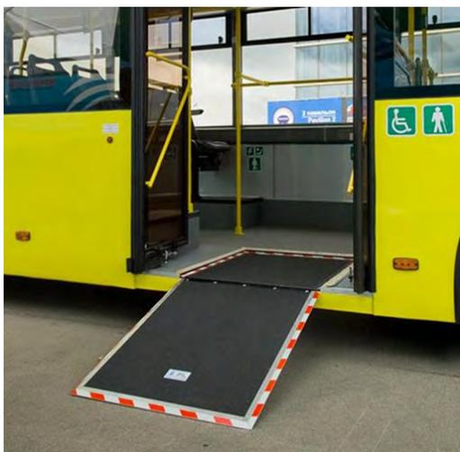
Рис. 4. Низкопольный автобус, приспособленный для перемещения людей в инвалидных колясках
