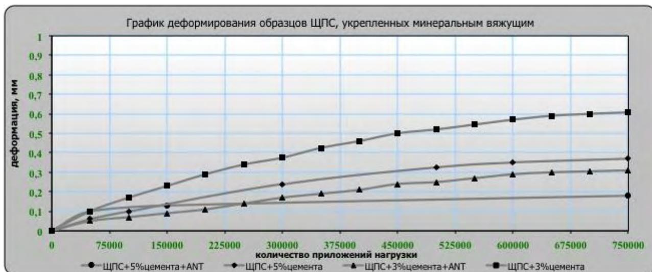
Рис. 2. График испытаний устойчивости щебеночно-песчаных смесей, укрепленных
