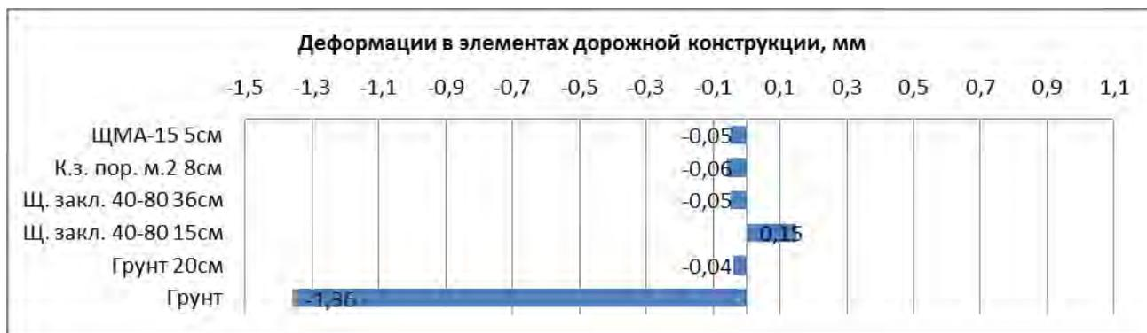
Рис. 3. Остаточные деформации конструктивных слоев дорожной одежды и грунта земляного полотна за период наблюдения 5 месяцев
