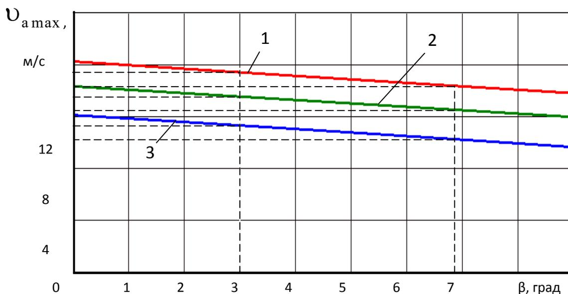
Рис. 3. Зависимость критической скорости автобуса от угла наклона дороги при различных значениях его коэффициента устойчивости: 1 – 0,9; 2 – 0,7; 3 – 0,5
