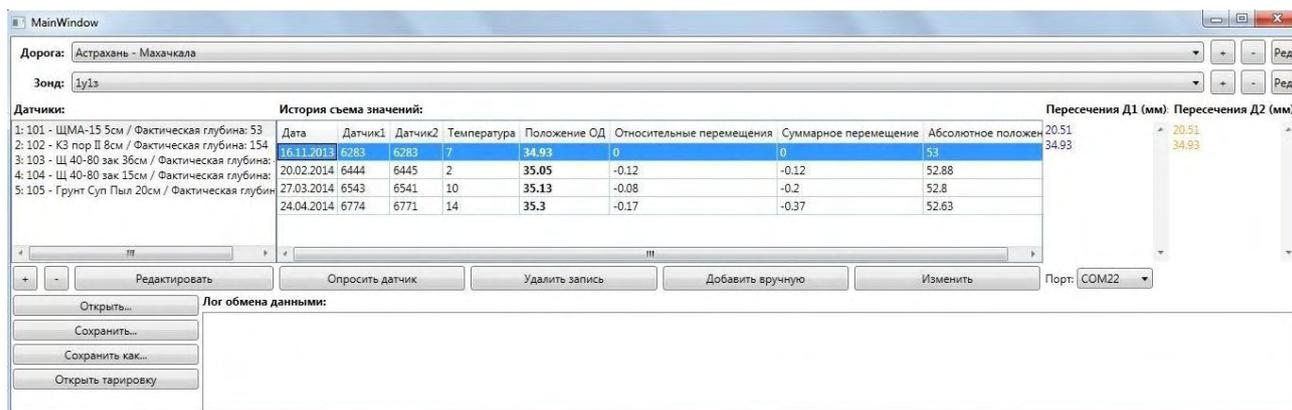
Рис. 2. Интерфейс программного обеспечения измерительных зондов
