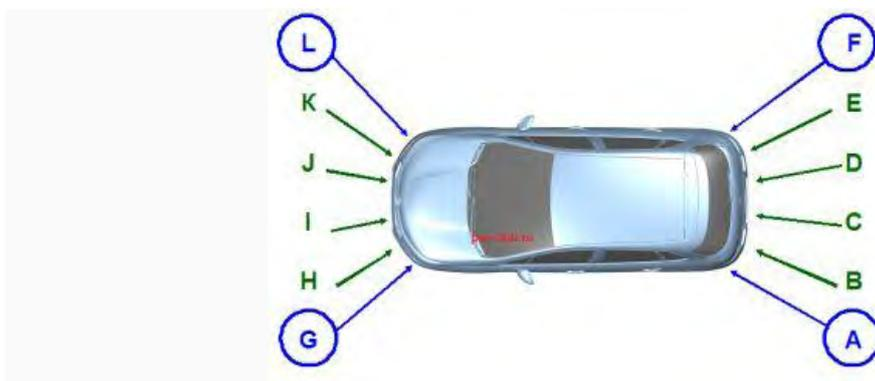
Рис. 3. Датчики препятствия системы наблюдения за мертвыми зонами
