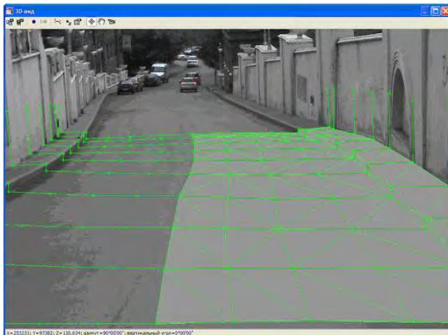
Рис. 6. Подготовка модели дороги для проектирования ремонтов в IndorCAD
