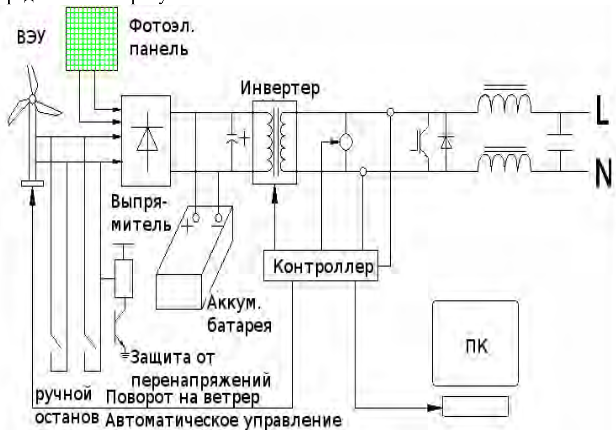
Рис. 1. Принципиальная электрическая схема гибридной установки [6].
