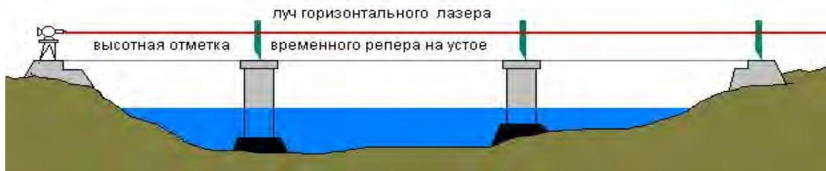
Рис.1. Схема определения положения плано-высотного положения элементов конструкций
