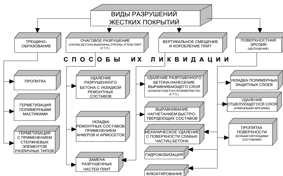
Рис.1 Способы ремонта жестких аэродромных покрытий в зависимости от вида их разрушения
