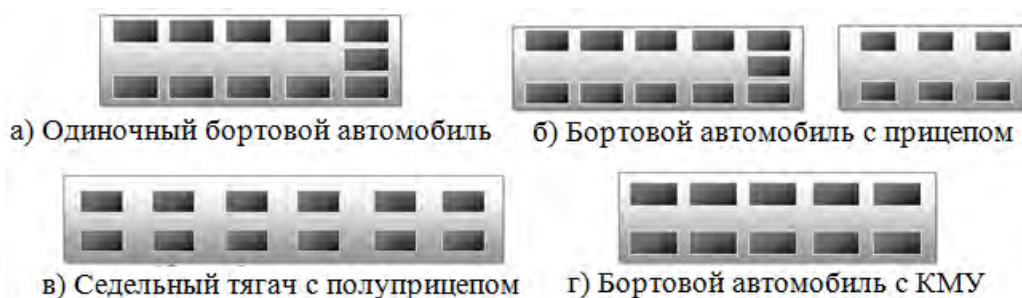
Рис. 4 Схемы размещения поддонов на подвижном составе по грузоподъемности автомобиля
