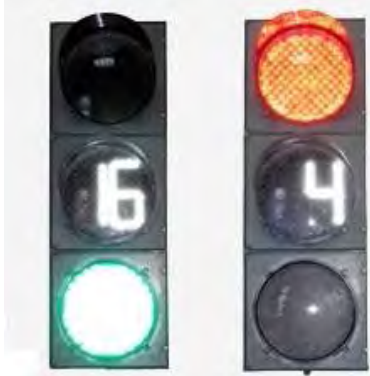
Рис.4 Транспортные светофоры с обратным отсчетом времени
