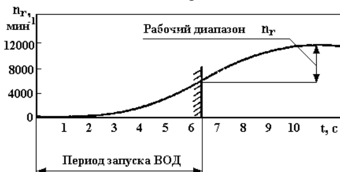
Рис.4. Разгонная характеристика самоприводного ротора ВОД В195.
