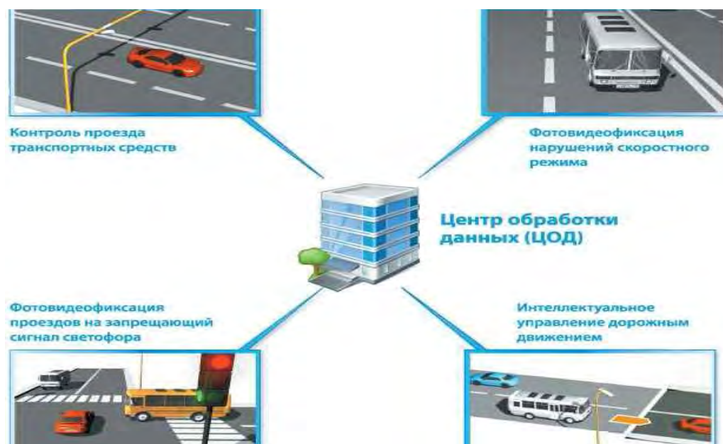
Рис. 3. Автоматизированная информационная система распознавания автомобильных номеров, интегрируемая со средствами контроля скорости и интеллектуальным видеооборудованием
