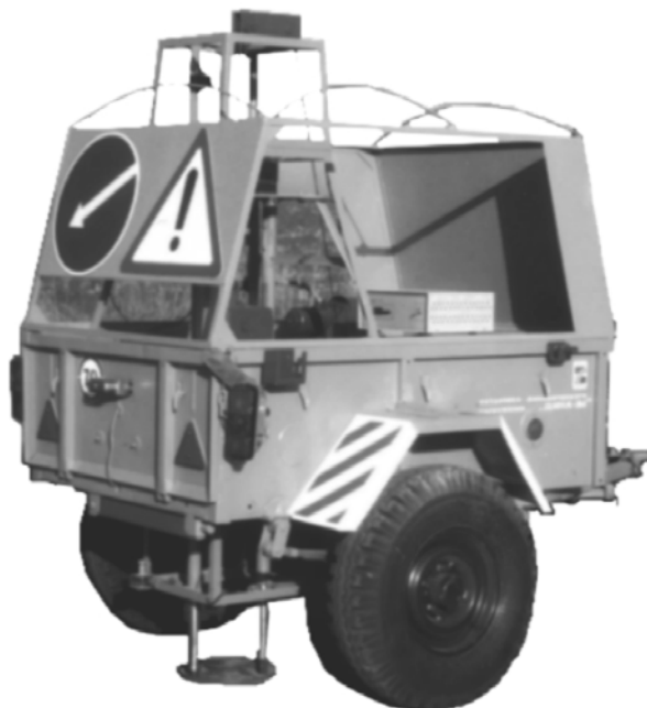
Рис. 2. Прицепная установка ДИНА-3М для измерения прочностных показателей дорожной одежды
