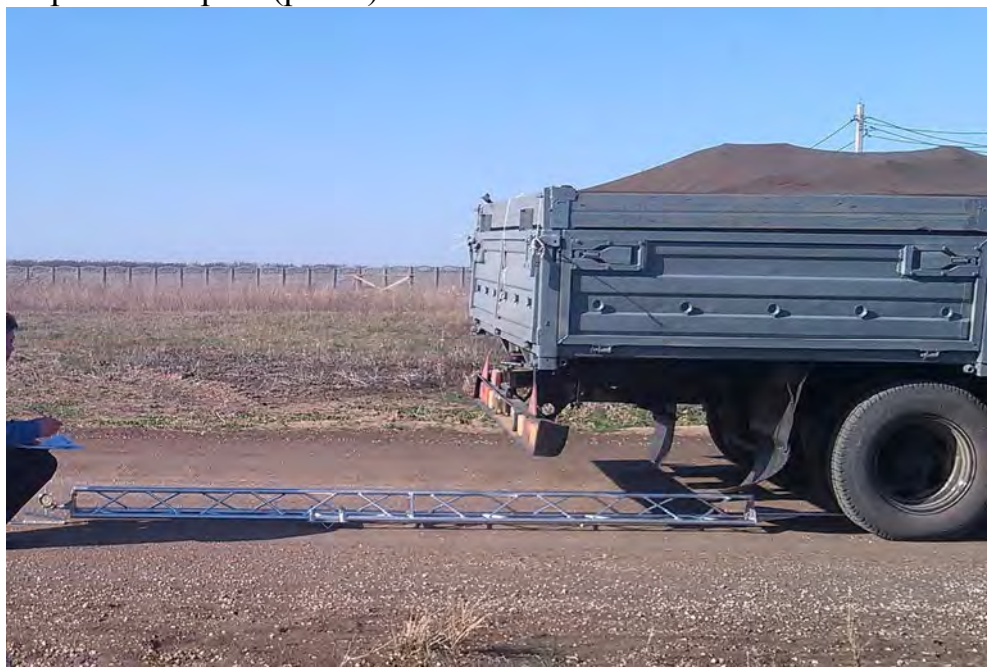
Рис. 1. Измерение прогиба дорожной одежды прогибомером
