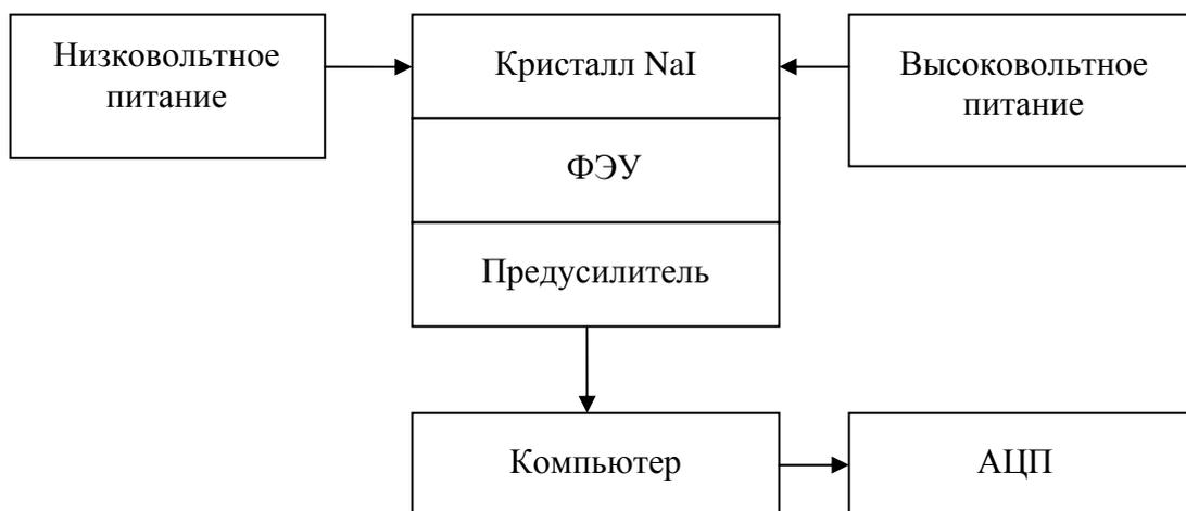
Рис.3 Блок-схема сцинтилляционного гамма-спектрометра
