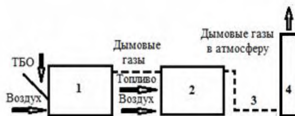
Рис. 1. Топливный и газозвоздушный тракт котельной с использованием топки для сжигания ТБО: 1 — выносная топка для сжигания ТБО; 2 — существующая теплогенерирующая установка; 3 — газоход; 4 — дымовая труба.
