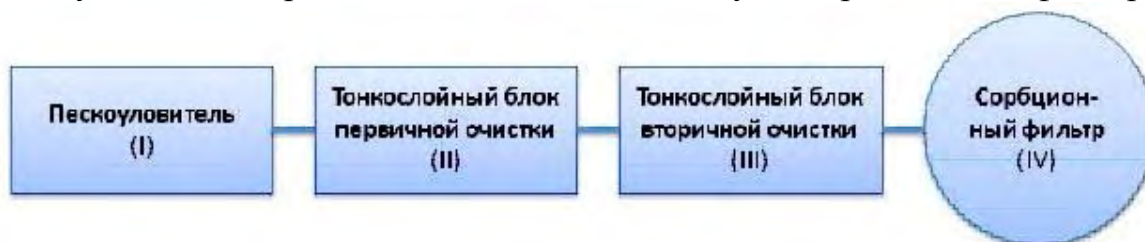
Рис.1. Схема очистки сточных вод от нефтепродуктов
