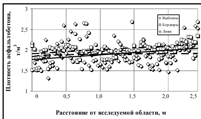
Рис. 1. Изменение плотности асфальтобетона в труднодоступных местах.
