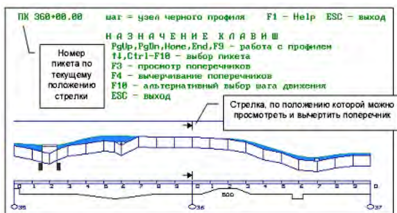
Рис. 14. Вид экрана при просмотре проектных поперечных профилей
