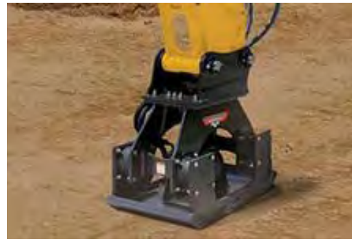
Рис. 5.2. Виброплиты: a — трамбовочная навесная шестигранная; б — трамбовочная навесная четырехгранная
