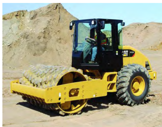
Рис. 5.1. Уплотнение грунта катками: a — гладкими; b — кулачковыми
