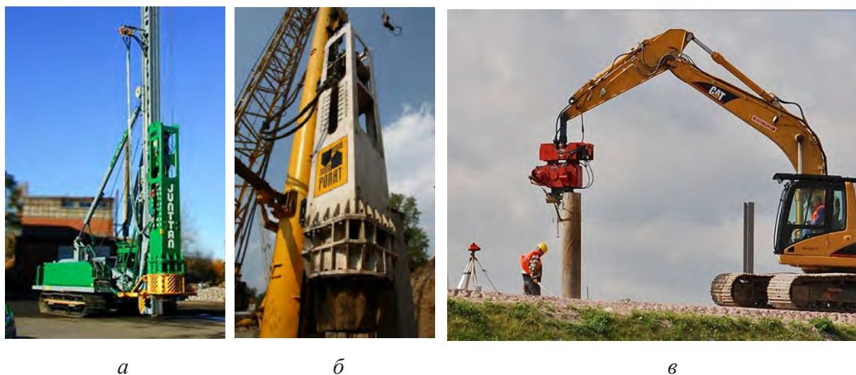
Рис. 5.20. Копровые установки с навесным оборудованием: а — с гидромолотом; б — с вибропогружателем; в — вибропогружатель на базе экскаватора
