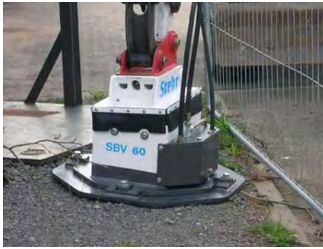
Рис. 5.2. Виброплиты: a — трамбовочная навесная шестигранная; б — трамбовочная навесная четырехгранная
