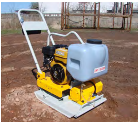
Рис. 5.4. Средства малой механизации: a — виброплита с поступательным движением; б — вибротрамбовка
