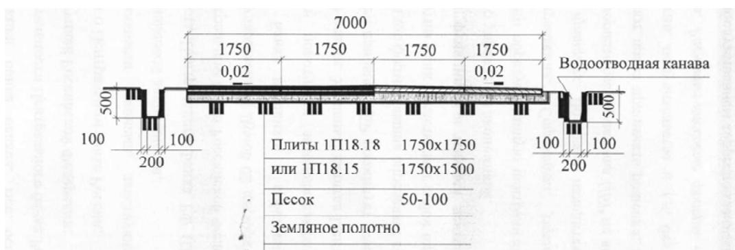
Рис. П.4.5. Тип 5. Двускатная дорога из сборных железобетонных плит шириной 7 м из плит 1750 × 1750
