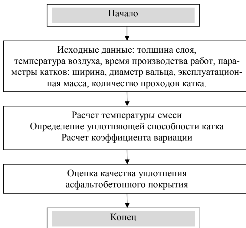
Рис. 14. Блок – схема оценки однородности уплотнения асфальтобетонного покрытия
